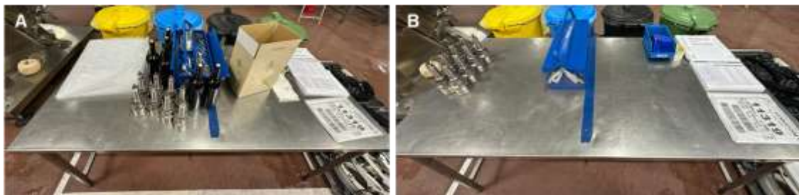
Figura 5.6: (A) Mesa de apoio ao monobloco de enchimento, antes da implementação dos 5S; (B) Mesa de apoio ao monobloco de enchimento, depois da implementação dos 5S
