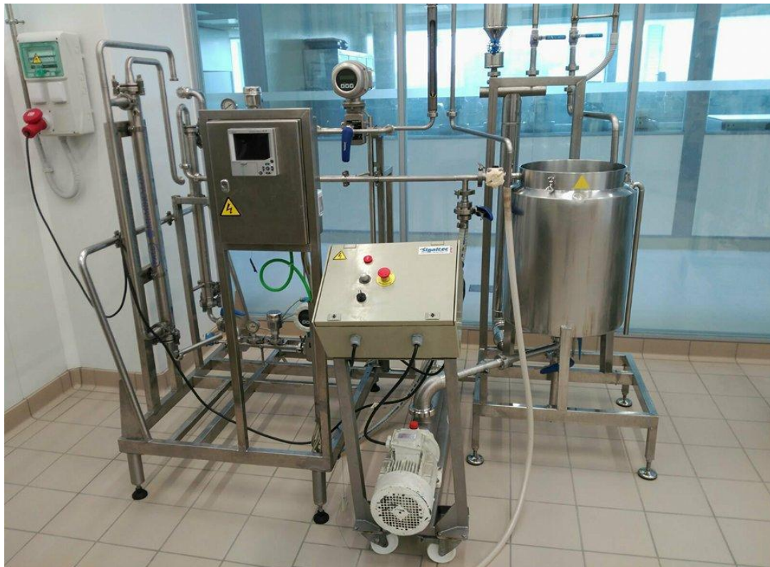
Figura 3.3 - Ultrafiltração por membranas da Aula de Productos Lácteos Tecnologías Alimentarias da Universidade de Santiago de Compostela
