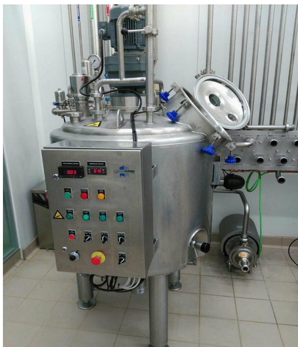
Figura 3.2 - Fermentador agitado com camisa de aquecimento, com capacidade de 1000 L.
