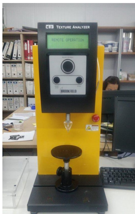
Figura 3.8 - Equipamento Brookfield CT-3 Texture Analyzer
