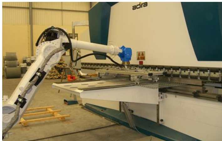
Figura 2: Célula de Quinagem Fonte: ADIRA
