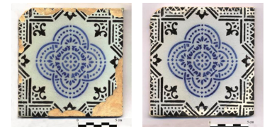
Figura 1. O mesmo azulejo antes e após o restauro por recozimento a 890 °C com aplicação de novo vidro e pintura
