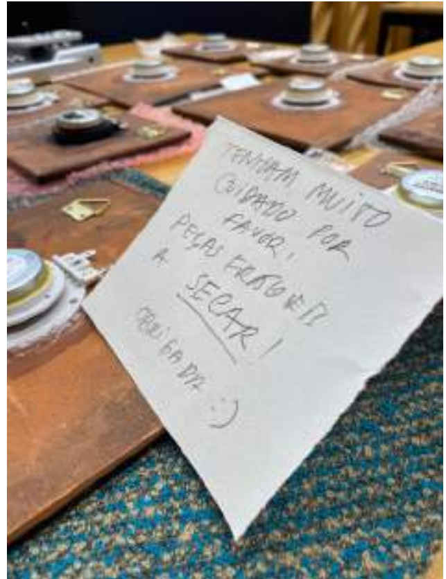
Figura 18: Registo fotográfico do momento de secagem das peças após terem sido presos os monitores com silicone (secagem de 24 horas).
