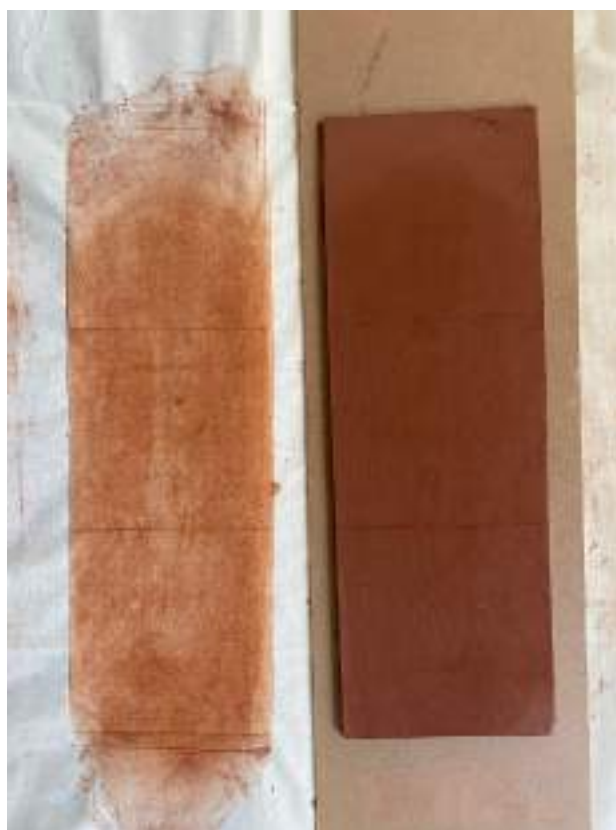
Figura 6: Cadeia de manufatura das peças de barro. Processo que compreende aumentar a rapidez e eficácia no momento de cortar a lastra em “azulejos” semelhantes.
