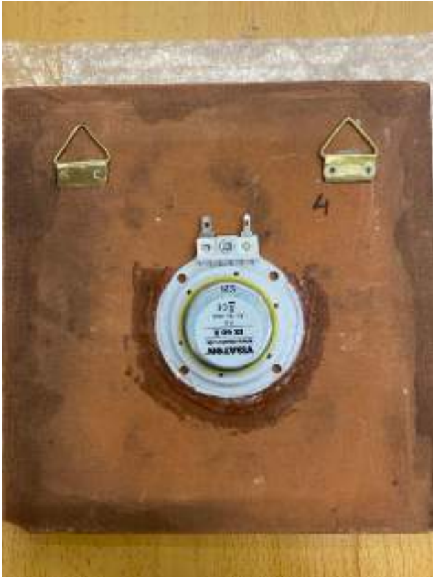
Figura 17: Peça de cerâmica com monitor e suporte de moldura já fixados.
