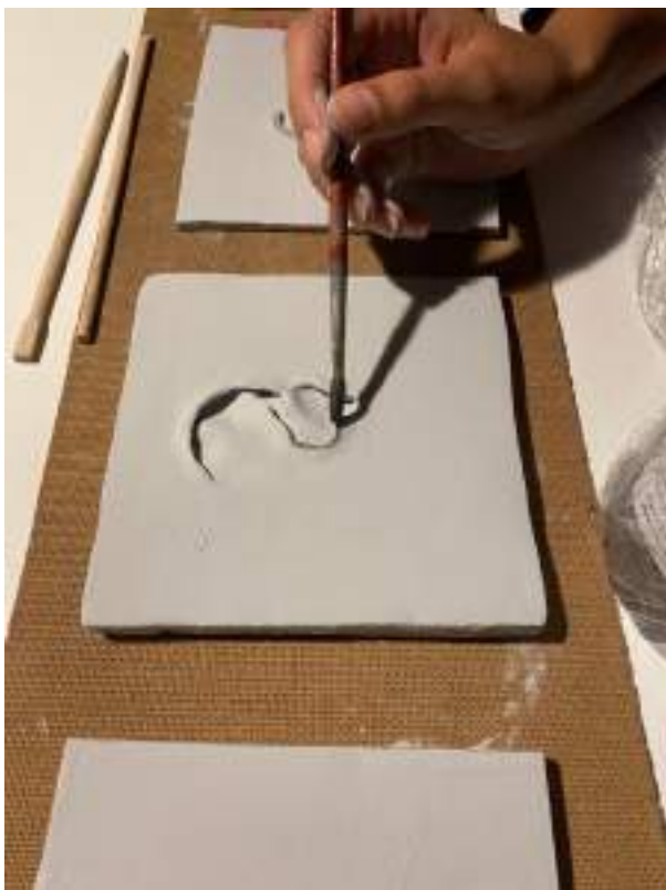
Figura 7: Processo de aplicação do vidrado sobre cada peça.
