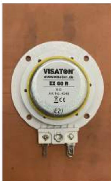
Figura 1: Monitores de som (colunas de indução) Vision EX 60 R .
