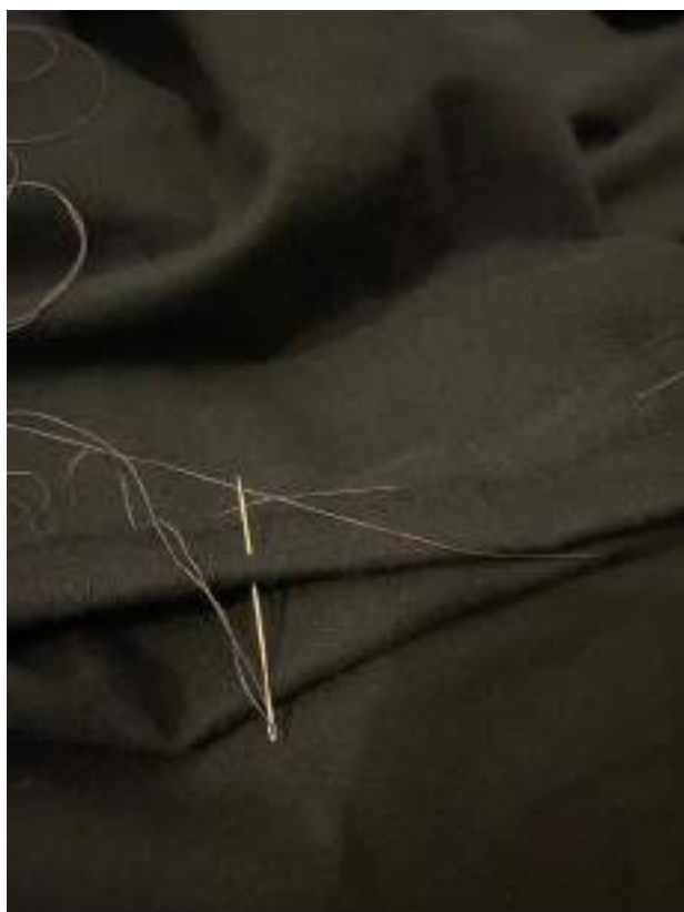
Figura 13: Cosedura à mão da bainha ao longo do tecido de flanela preta.
