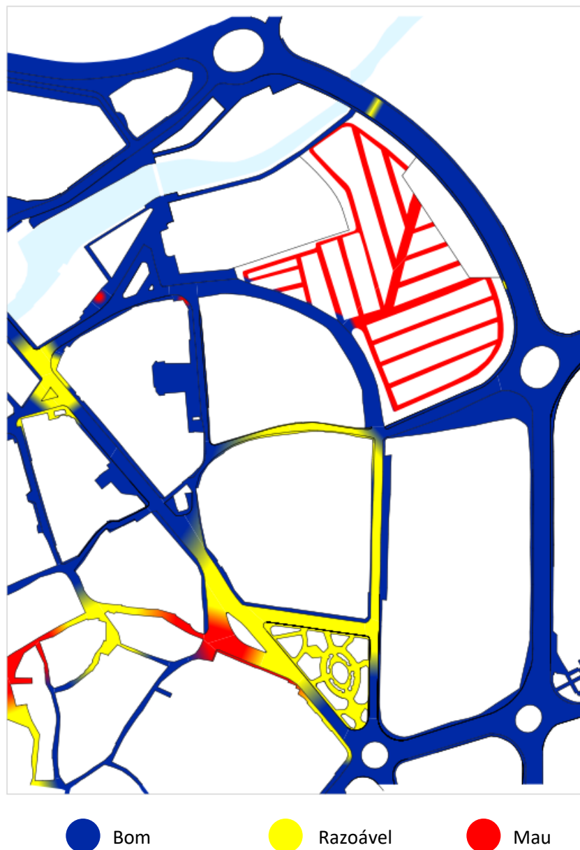
Fig. 11 – Análise ao estado de conservação das vias
