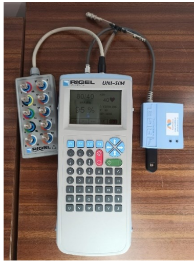
Figura 5 Analisador de sinais vitais Rigel Uni-Sim. O módulo à esquerda é responsável pela análise de ECG; O módulo à direita é responsável pela análise de oximetria. Fonte: própria.
