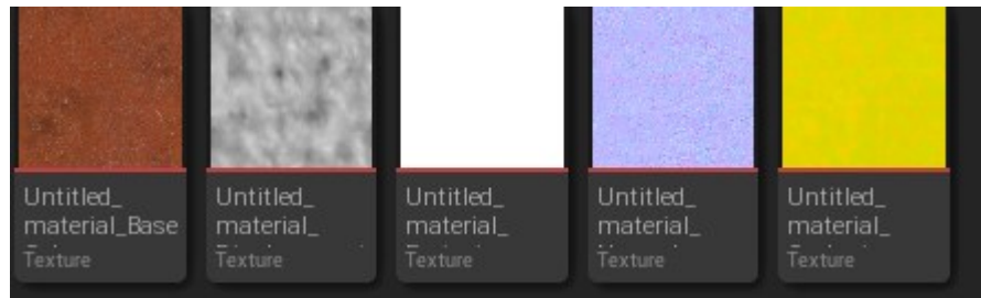
Figura 11- Mapas Gerados em Adobe Substance Sampler. Por ordem da esquerda para a direita: Color Map-Displacement Map-Emissive(Não foi utilizado)-Normal Map- Pak(Nos canais RGB contem respetivamente a informação Ambient Occlusion, Roughness e Metallic)
