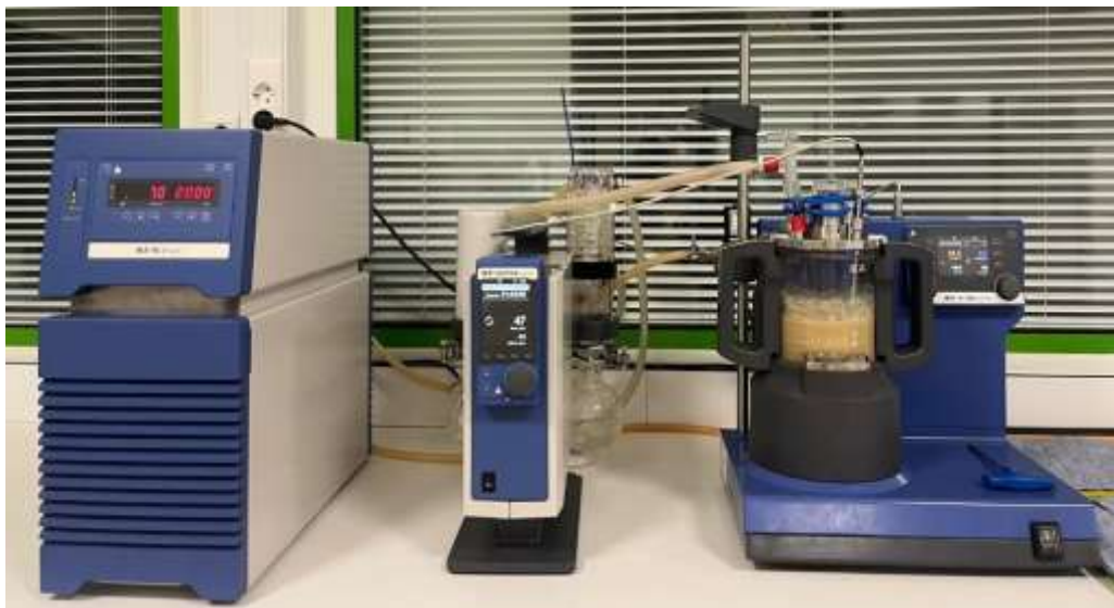
Figura 2.6: IKA, Reator de processamento modular com controle de temperatura, pressão e agitação utilizado no laboratório da BENEFIT
