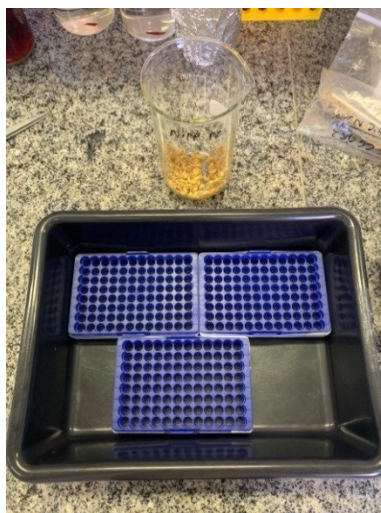
Figura 2 - Sistema hidropônico montando com caixas de ponteiras
