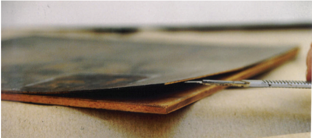
Figura 25 – Busto de Mulher (UP-CMAS-000180). Delaminação da quarta folha.
