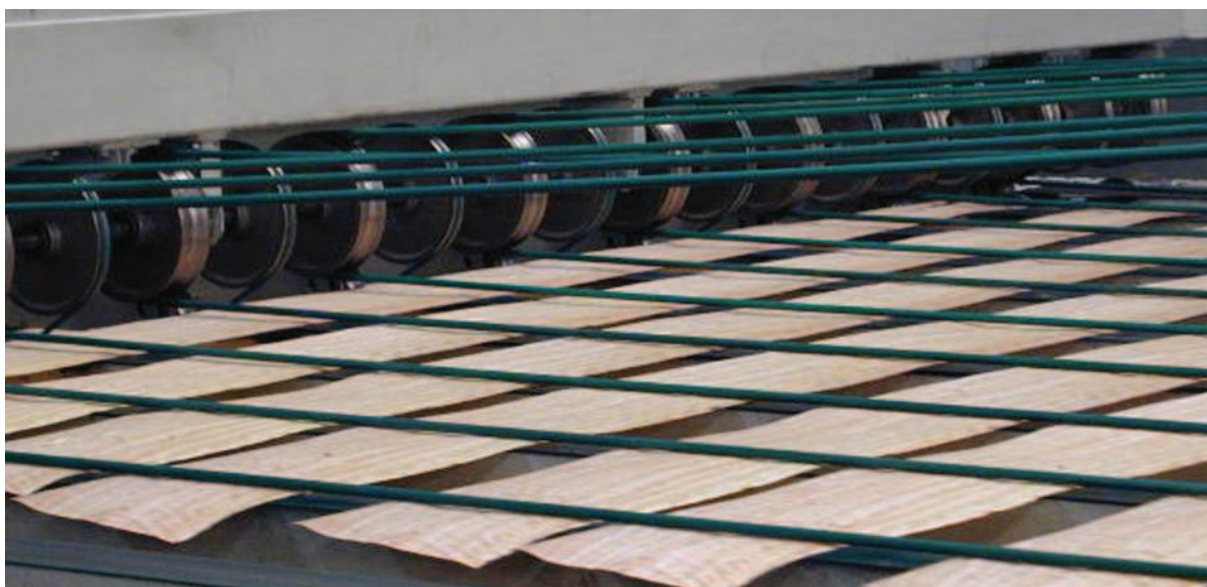
Figura 2 – Folhas de madeira obtidas pelo corte plano.
