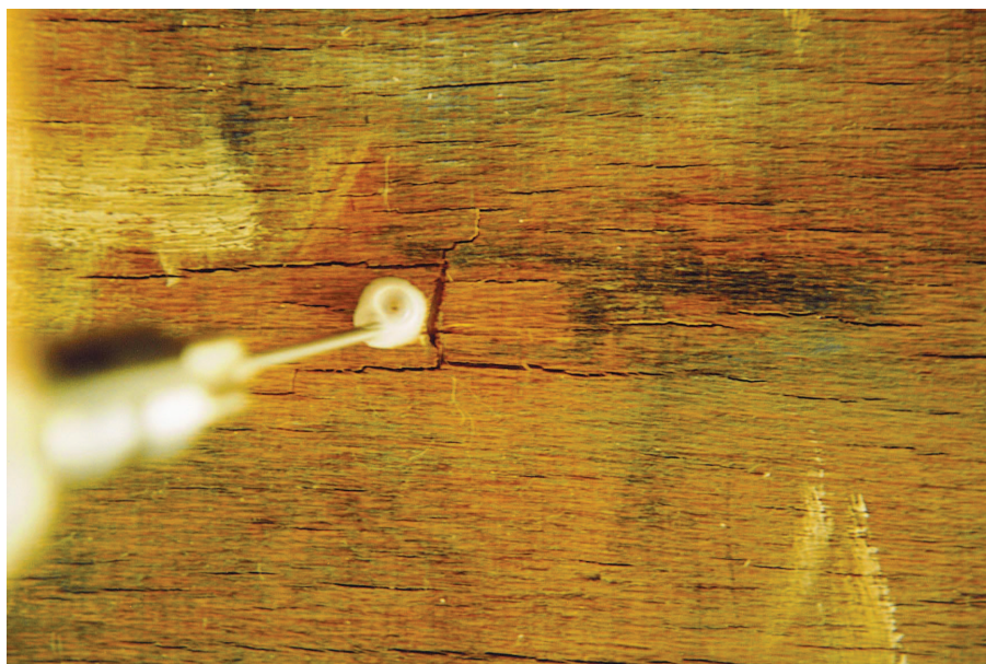
Figura 9 – Mulheres (48,0 cm x 35,5 cm), a fenda contrariou o fio da madeira, o que revela ter havido podridão cúbica.
