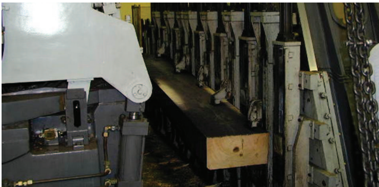
Figura 1 – Tronco a ser laminado através do corte plano.
