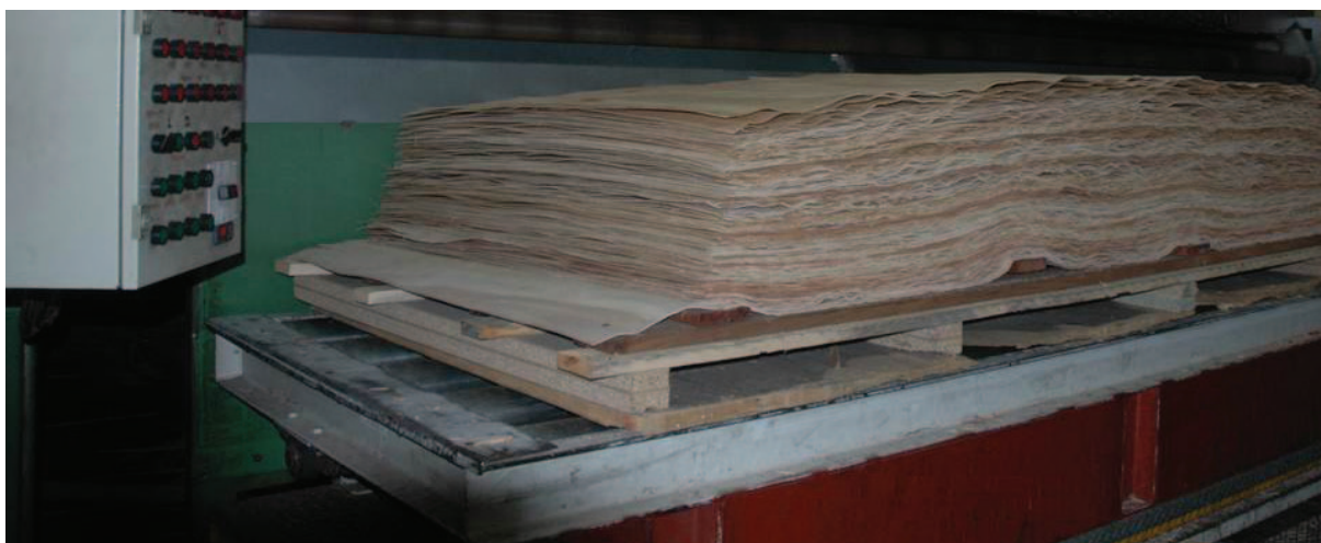
Figura 6 – Folhas desenroladas empilhadas, prontas para serem usadas no fabrico do contraplacado.
