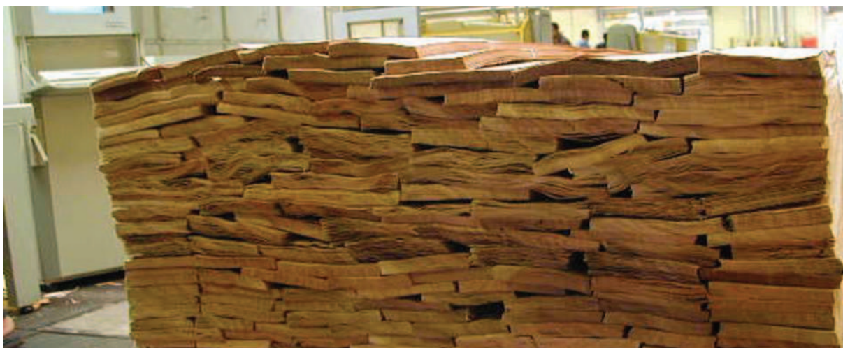
Figura 3 – Conjunto de folhas de madeira empilhadas, prontas para serem usadas no fabrico do contraplacado.
