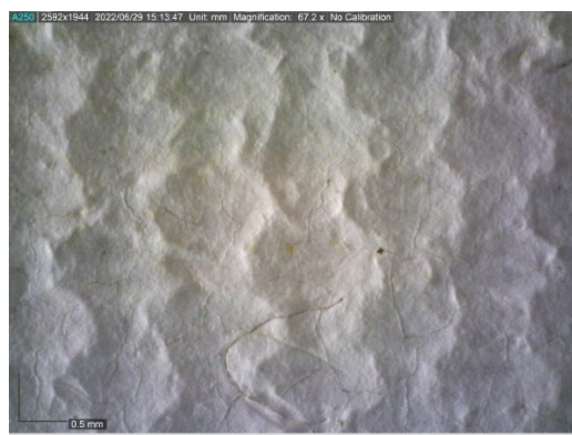
Figura 51: Macrofotografia do resultado do teste de solubilização e remoção da tinta amarela aglutinada com goma arábica na amostra sobre tela de envelhecimento natural: remoção quase total.
