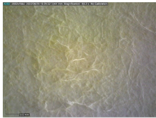
Figura 49: Macrofotografia do resultado do teste de solubilização e remoção da tinta amarela aglutinada com Tylose® sobre suporte de papel na amostra de envelhecimento natural: elevado grau de remoção e levantamento das fibras.
