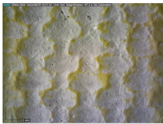
Figura 52: Macrofotografia do resultado do teste de solubilização e remoção da tinta amarela aglutinada com Lascaux® na amostra sobre tela de envelhecimento natural: reduzida remoção e presença de tinta nas reentrâncias da textura da camada de preparação/trama.
