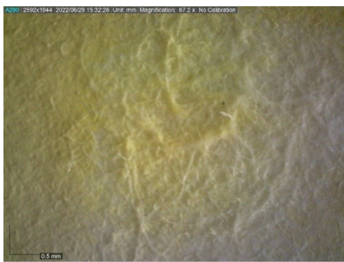
Figura 50: Macrofotografia do levantamento de fibras do suporte de papel ocorrido após o teste de solubilização e remoção da tinta amarela aglutinada com Lascaux® na amostra de envelhecimento natural: reduzido grau de remoção e evidente levantamento das fibras.
