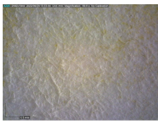
Figura 48: Macrofotografia do levantamento de fibras do suporte de papel após o teste de solubilização e remoção da tinta amarela aglutinada com Lascaux® na amostra controle.
