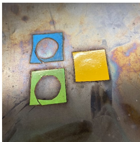
Fig. 82. Depois da limpeza mecânica, com recurso a uma borracha STAEDLER Mars plastic®, da superfície de uma etiqueta em vinil autocolante amarela. Fonte: ©Francisca Lafuente.
