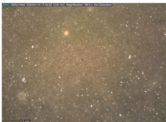
Fig. 64. Partículas sólidas de cor branca ocasionadas pela migração do plastificante à superfície da camada de emulsão da radiografia que compõe o elemento 6. Fotografia captada com recurso ao microscópio digital portátil Dino-Lite ®. Fonte: ©Francisca Lafuente.
