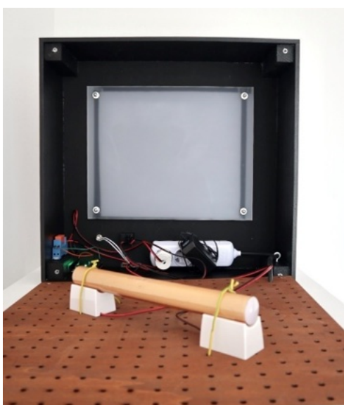
Fig. 124. Protótipo (interior). Pormenor dos filtros que revestem a lâmpada LED tubular de 220VAC 5W 2500..3000K 360lm. Fonte: ©Francisca Lafuente.
