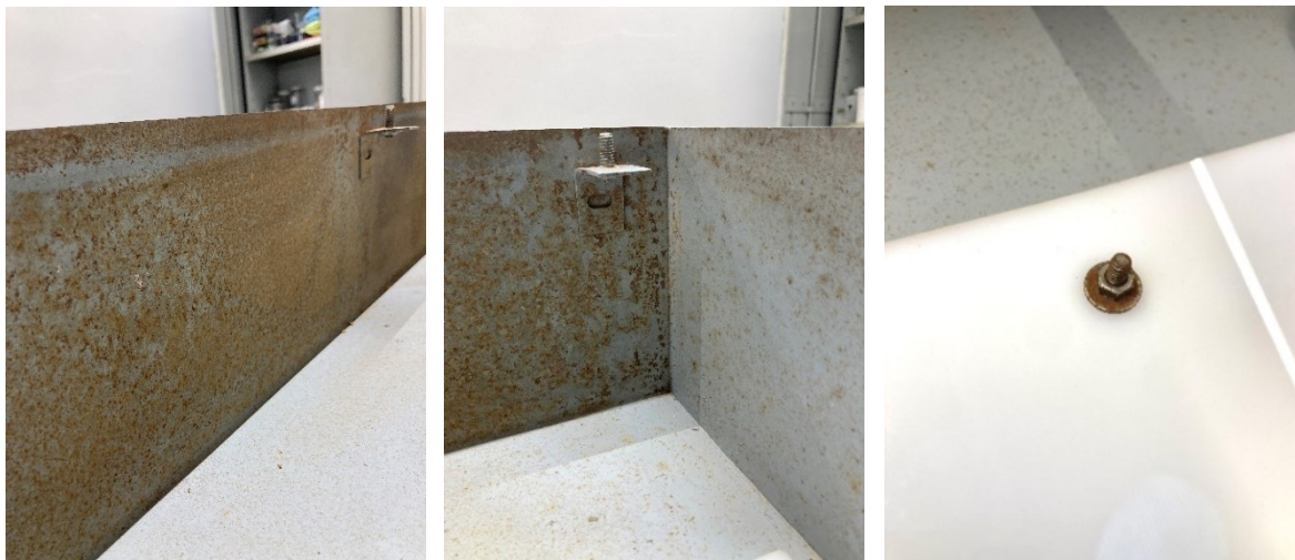
Fig. 44. Pátina castanha-alaranjada característica das ligas de ferro presente em diferentes concentrações na superfície da chapa metálica e nos elementos de ligação metálicos (esquadros angulares, parafusos, anilhas e porcas) do elemento 1. Fonte: ©Francisca Lafuente.
