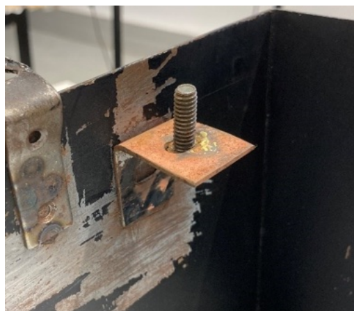
Fig. 26. Registo de pormenor da chapa em ferro, quinadas em formato L, soldada ao interior da face superior da chapa metálica do elemento 7. Fonte: ©Francisca Lafuente.
