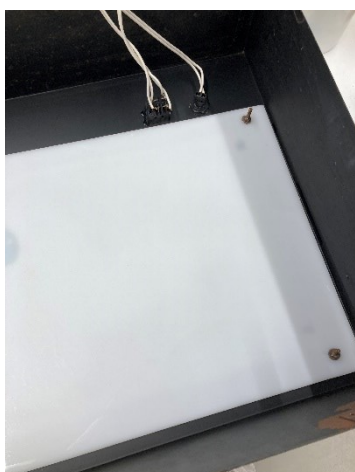
Fig. 23. Sistema de fixação das placas de acrílico à chapa metálica através da utilização de parafusos de máquina cilíndricos, anilhas e porcas. Fonte: ©Francisca Lafuente.
