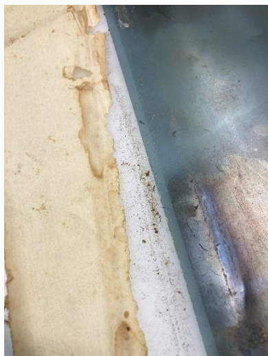
Fig. 55. Sujidade generalizada acumulada nas áreas destacadas da tira de papel de tonalidade branca localizada ao redor das radiografias do elemento 1. Fonte: ©Francisca Lafuente.
