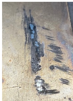
Fig. 66. Lacunas e abrasões identificadas na camada de emulsão de uma das radiografias do elemento 1. Fonte: ©Francisca Lafuente.
