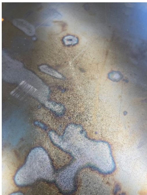
Fig. 67. Abrasões, manchas de humidade, manchas amarelas-marron, efeito espelho de prata e bolhas ou partículas sólidas de cor branca presentes na camada de emulsão de uma das radiografias do elemento 1. Fonte: ©Francisca Lafuente.
