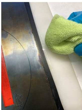
Fig. 84. Limpeza mecânica, com recurso ao pano de microfibras, da superfície de uma placa de acrílico. Fonte: ©Francisca Lafuente.
