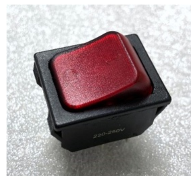
Fig. 100. Interruptor luminoso basculante vermelho de substituição depois de se proceder à pintura do seu interior. Fonte: ©Francisca Lafuente.
