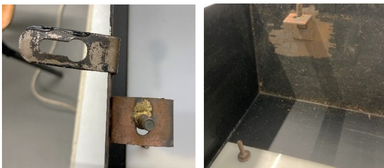
Fig. 45. Pátina castanha-alaranjada característica das ligas de ferro presente na superfície de uma ferragem de suspensão e de um esquadro angular do elemento 5. Fonte: ©Francisca Lafuente.
