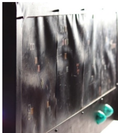
Fig. 71. Fotografia de luz rasante das deformações e ondulação das películas de poliéster que constituem as radiografias do elemento 1. Fonte: ©Francisca Lafuente.
