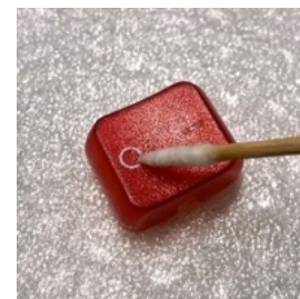
Fig. 97. Remoção das inscrições a branco presentes na superfície do plástico vermelho, com recurso a um cotonete de algodão embebido em etanol. Fonte: ©Francisca Lafuente.
