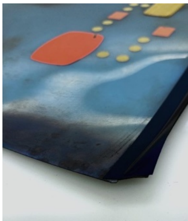
Fig. 69. Deformações e perda de aderência do adesivo utilizado na fita adesiva preta que realiza a união da radiografia do elemento 6 à placa de acrílico. Fonte: ©Francisca Lafuente.
