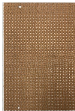
Fig. 93. Placa de platex perfurado de substituição antes de ser aplicada a camada de acetato de polivinilo (PVA). Fonte: ©Francisca Lafuente.
