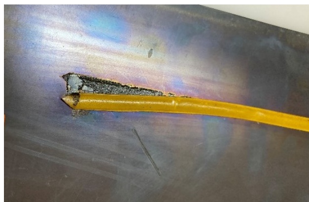
Fig. 60. Deslocamento, na direção descendente, de uma etiqueta refletora pertencente ao elemento 8, decorrente da perda de aderência do seu adesivo à superfície da radiografia. Fonte: ©Francisca Lafuente.
