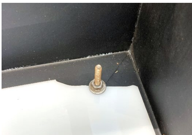
Fig. 53. Canto partido da placa de acrílico que do elemento 4. Fonte: ©Francisca Lafuente.
