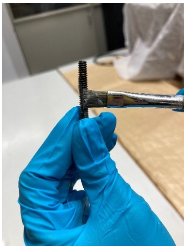
Fig. 104. Aplicação, com recurso a um pincel de cerdas macias, de uma camada da cera microcristalina translúcida RENAISSANCE® Micro-crystalline Wax Polish sobre a superfície dos parafusos de ligação. Fonte: ©Francisca Lafuente.
