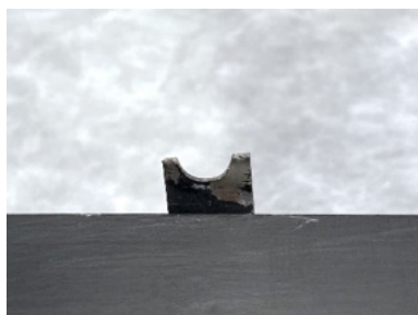
Fig. 49. Rotura de uma ferragem de suspensão pertencente ao elemento 2. Fonte: ©Francisca Lafuente.
