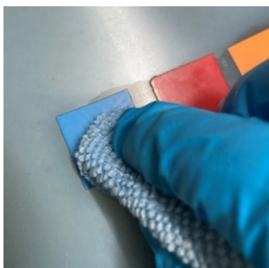
Fig. 79. Limpeza mecânica, com recurso a um pano de microfibras, da superfície das etiquetas em vinil autocolante. Fonte: ©Francisca Lafuente.
