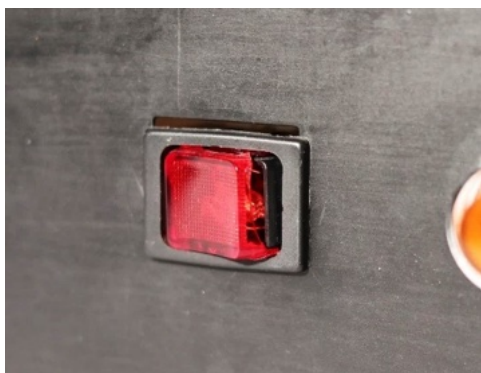
Fig. 56. Interruptor luminoso basculante vermelho partido do elemento 6. Fonte: ©Francisca Lafuente.
