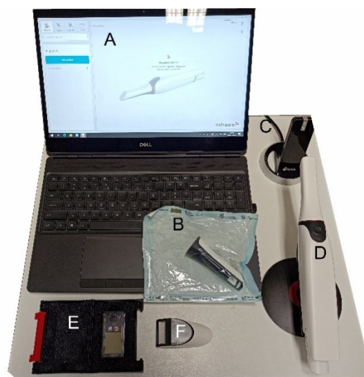
Figura 9. Material utilizado no registo intermaxilar digital – Scanner intra-oral e componentes
