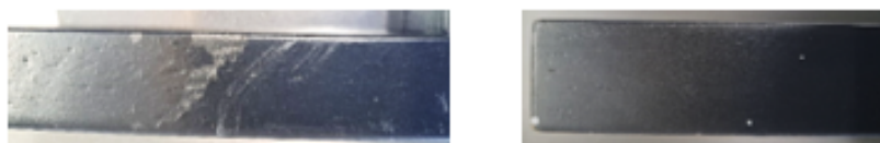
Figura 4 e 5 – Pormenor de destacamento da camada cromática e sinais de abrasão (8/13) e presença de material exógeno (pigmento branco) (10/13), respetivamente.
