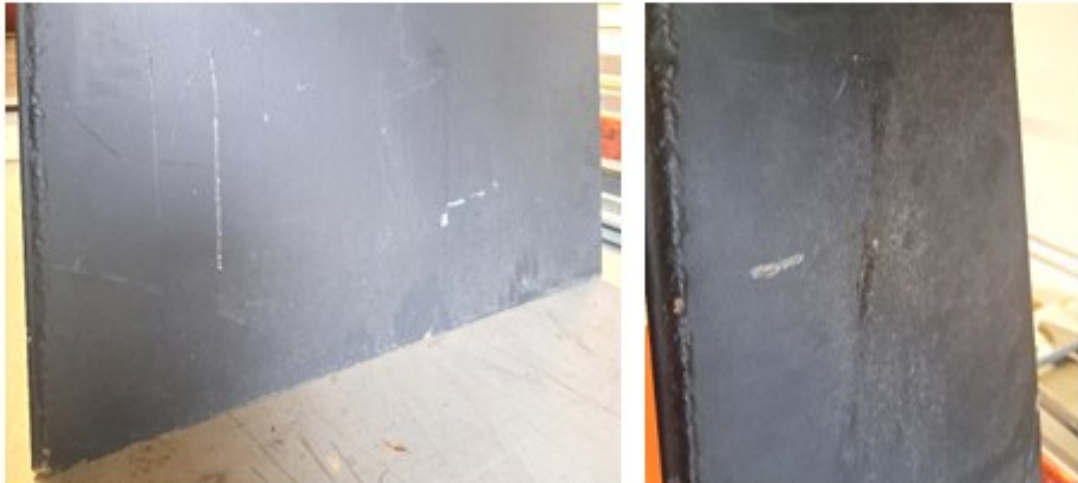
Figura 3 e 4 – Pormenores das zonas com abrasão e, consequentemente, destacamentos da camada cromática e corrosão pontual.
