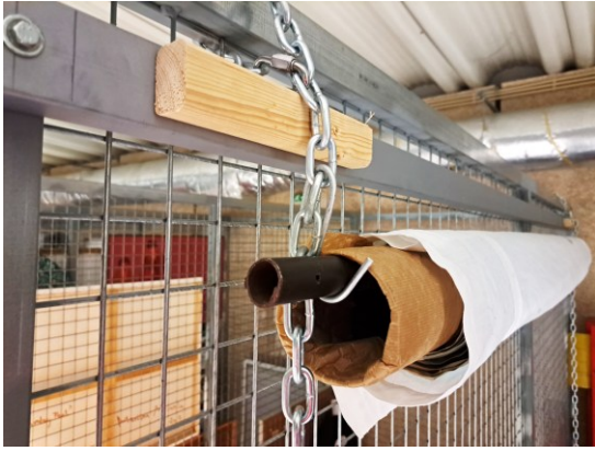
Fig. 45 – Estrutura executada para suspensão de rolos. Fotografia da autora.
