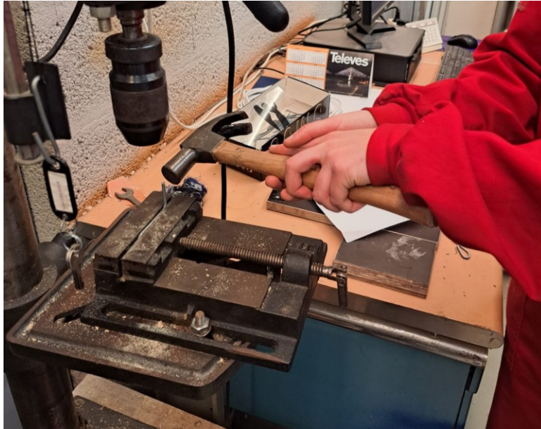
Fig. Apêndice 53 - Produção de ganchos, com auxílio de torno e martelo. Fotografia da autora.
