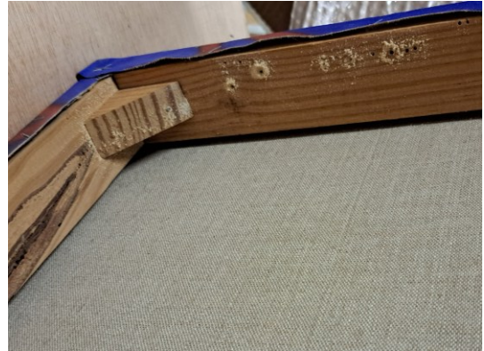
Fig. 14 - Sinais de infestação ativa, numa pintura armazenada na reserva, Fotografia da autora.
