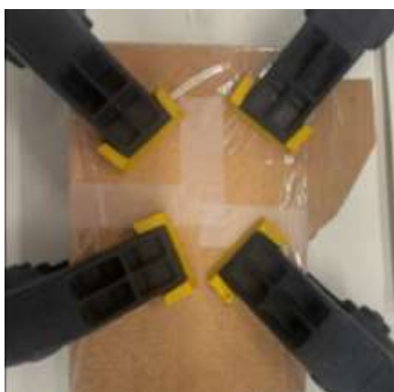
Figura 91 - Colagem das placas de madeira
