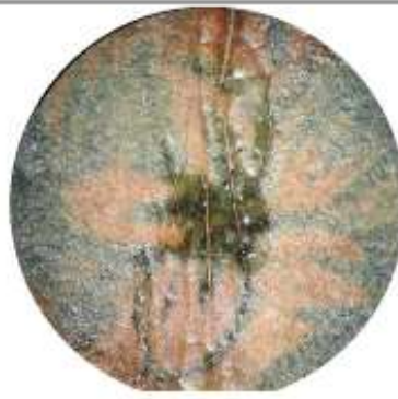
Pormenor no papel de fundo, lupa binocular, iluminação incidente: processo de remoção da cola proteica, antes, durante aplicação de Tylose e após remoção, respetivamente
