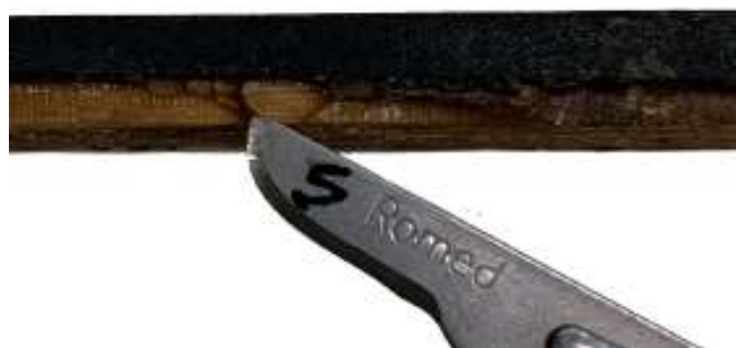
Figura 20 - Remoção de amostra em que foi identificada cola animal. Fonte: Ana Machado (LJF)
