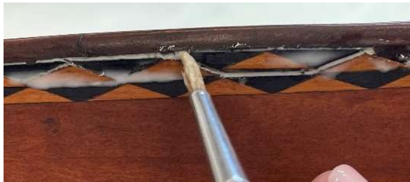
Figura 48 - Colagem dos embutidos com adesivo PVAc
