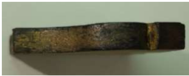
Figura 34 - Limpeza química da camada dourada
