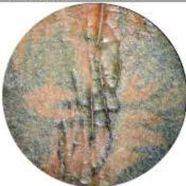
Pormenor no papel de fundo, lupa binocular, iluminação incidente: processo de remoção da cola proteica, antes, durante aplicação de Tylose e após remoção, respetivamente
