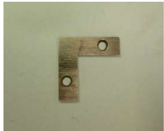
Figura 44 - Fim da limpeza dos elementos metálicos
