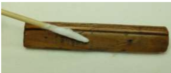
Figura 33 - Limpeza com tensoativo
