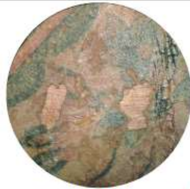
Pormenor papel de fundo, lupa binocular, iluminação incidente (lacunas causadas por insetos)
