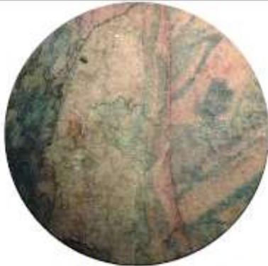
Pormenor recorte, lupa binocular, iluminação incidente (lacunas superficiais causadas por insetos)
