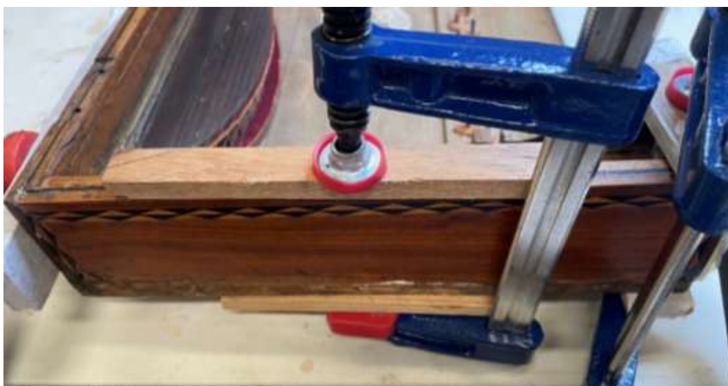
Figura 58 - Colagem do fundo à ilharga esquerda
