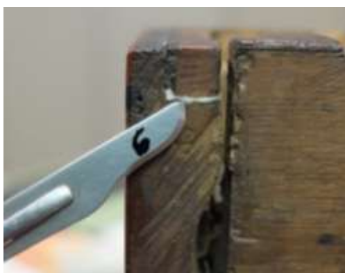
Figura 21 - Remoção de amostra em que foi identificado um adesivo polivinílico (PVA). Fonte: Ana Machado (LJF)
