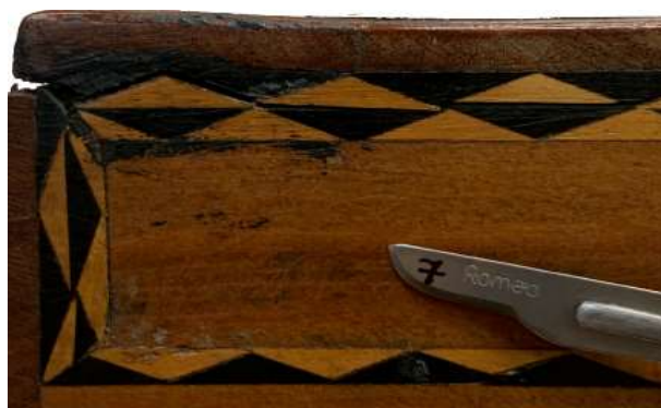
Figura 24 - Remoção de amostra em que foi identificada uma cera. Fonte: Ana Machado (LJF)
