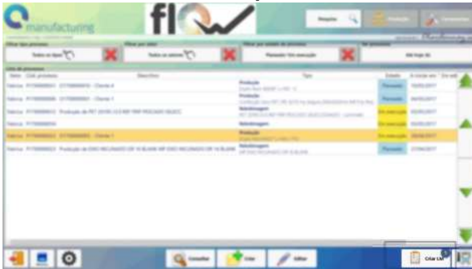
Figura 76 - Procedimento de criação de lista de materiais, através do módulo de Produção / Embalamento, na interface FO. Legenda: 1 - Carregar no botão "Criar LM", para dar início ao processo de criação da lista de materiais.
