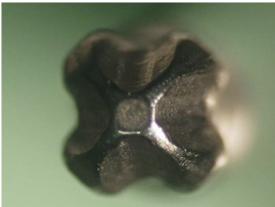
Figura 68 - Chave de Aperto após 30 Ciclos a 30° (ampliação 4x)
