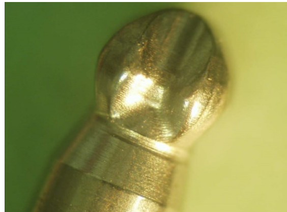
Figura 86 – Vista lateral da Chave de Aperto após Torque Máximo (ampliação 4x)
