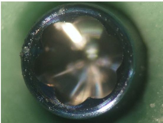
Figura 72 - Parafuso após 10 Ciclos a 0° (ampliação 4x)
