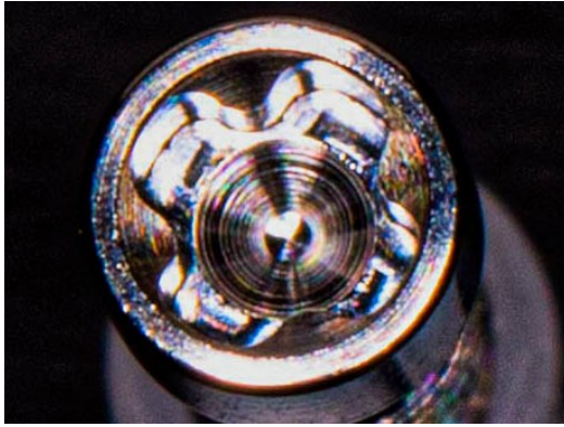
Figura 13 – Cabeça do Parafuso do Sistema UBH30® de 4 estrias
