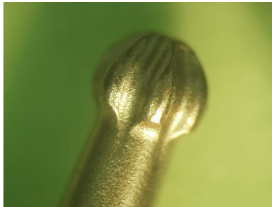
Figura 89 - Vista lateral da Chave de Aperto após Torque Máximo (ampliação 4x)
