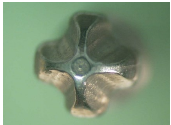
Figura 62 - Chave de Aperto após 30 Ciclos a 0° (ampliação 4x)
