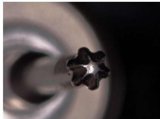
Figura 16 - Chave de aperto do Sistema UBH30® de 6 estrias
