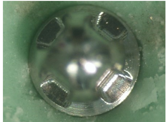
Figura 52 - Parafuso após 10 Ciclos a 30^\circ (ampliação 4x)
