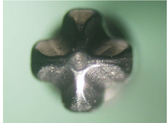
Figura 58 - Fotografia Inicial da Chave de Aperto (ampliação 4x)
