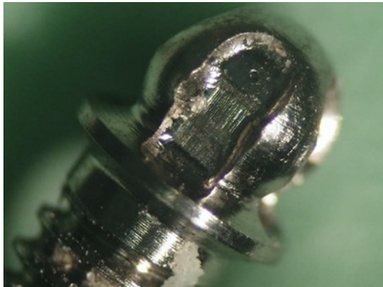
Figura 47 - Vista Lateral do Parafuso após 10 Ciclos a 0° (ampliação 4x)
