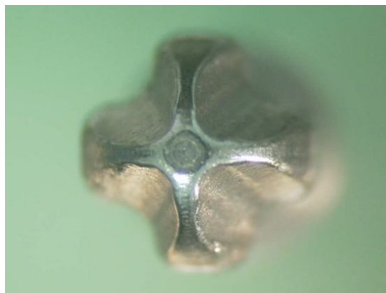
Figura 65 - Chave de Aperto após 17 Ciclos a 0^\circ (ampliação 4x)
