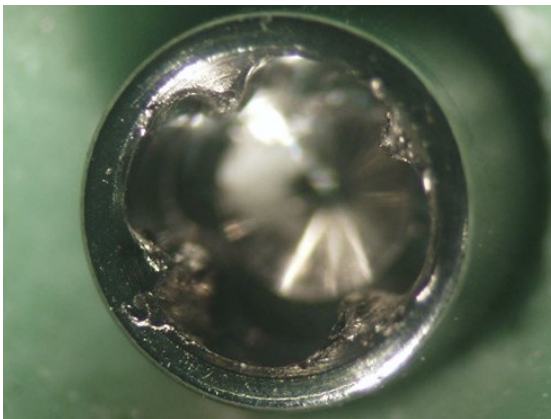
Figura 63 – Parafuso após 17 Ciclos a 0^\circ (ampliação 4x)
