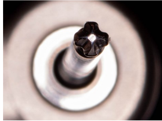
Figura 14 – Chave de aperto do Sistema UBH30® de 4 estrias
