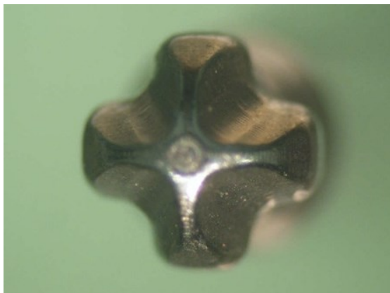
Figura 61 - Chave de Aperto após 10 Ciclos a 0° (ampliação 4x)
