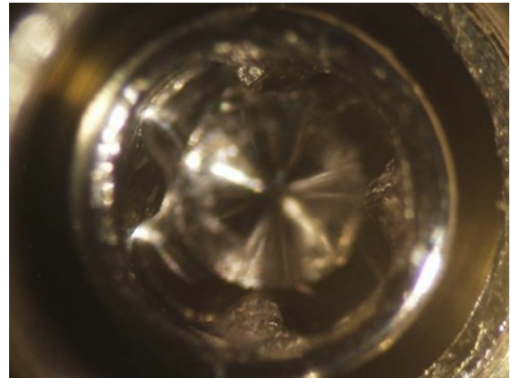
Figura 67 - Parafuso após 30 Ciclos a 30° (ampliação 6x)
