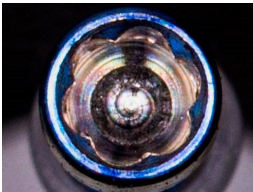
Figura 15 - Cabeça do Parafuso do Sistema UBH30® de 6 estrias
