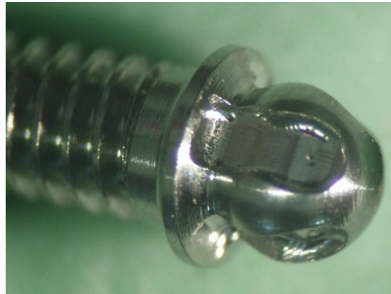
Figura 44 - Fotografia Inicial da Vista Lateral do Parafuso (ampliação 4x)
