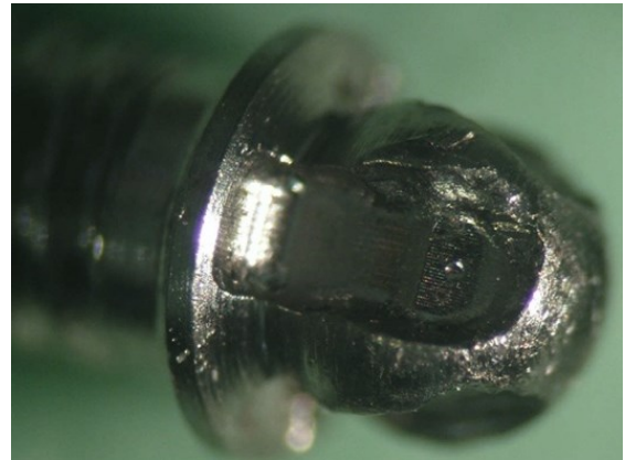
Figura 48 - Vista Lateral do Parafuso após 30 Ciclos a 0° (ampliação 4x)
