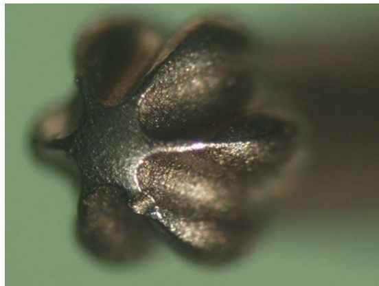
Figura 80 - Deformação na Chave de Aperto após 30 Ciclos a 30° (ampliação 11x)
