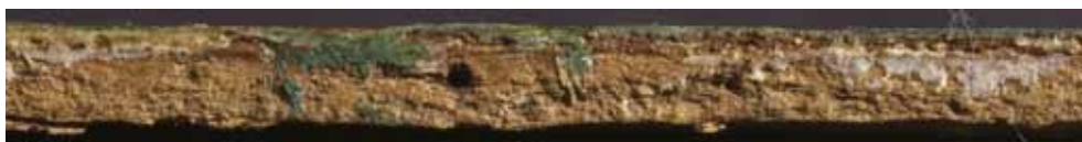
Fig. 4 - Tarde no Campo . Secção transversal. Casa-Museu Marta Ortigão Sampaio. Ao comparar este tipo de cartão com os processos descritos na época, encontram-se muitas semelhanças com o método Pasteboard já descrito, anteriormente
