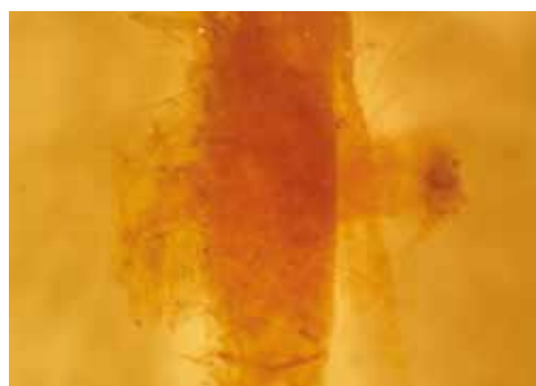
Fig. 2 - Sobreposição de folhas individuais para construção do cartão laminar (OM, ampliação de 40x).
