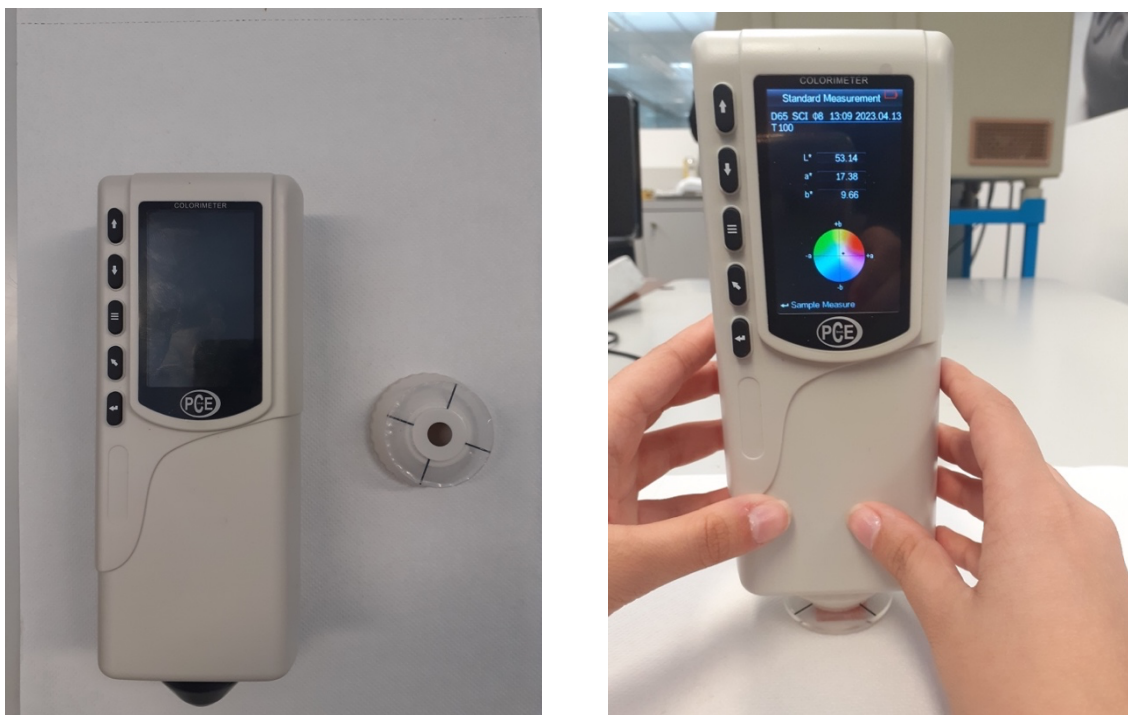
Figura 13. A - Colorímetro; B - Medição da cor dos provetes com recurso ao colorímetro
