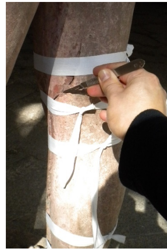
Figura 38 Pierna derecha de figura masculina. Muestra 8. Superficie de añadido de hormigón pigmentado.
