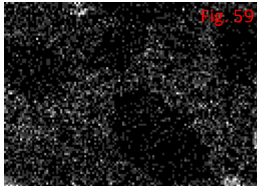
Figura 59, 60 y 61 Mapa de EDS de Figura 57. En figura 59, presencia de Carbono (C), en figura 60 presencia de Oxígeno (O) y en figura 61 presencia de Silicio (Si).
