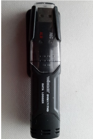
Figura 276 Datalogger marca Welleman modelo DVM171THD, utilizado para el registro de temperatura y humedad relativa.
