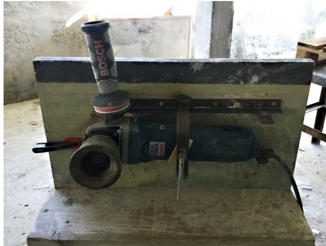
Figura 255 Equipo para desbastar piedra, utilizado por el departamento de Escultura de la FBAUP. Es una amoladora acoplada a una estructura funcional que le sostiene, permitiendo manipular la pieza de piedra en vez de la herramienta. Lleva instalada una muela de taza de carburo de silicio.
