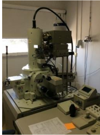
Figura 30 Microscopio electrónico de rastreo Jeol JSM6700F con detector de EDS Oxford Inca Energy 300 SEM.
