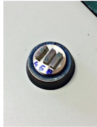
Figura 31 Muestra preparada para ser analizada en Microscopio Electrónico FE-SEM-EDS.
