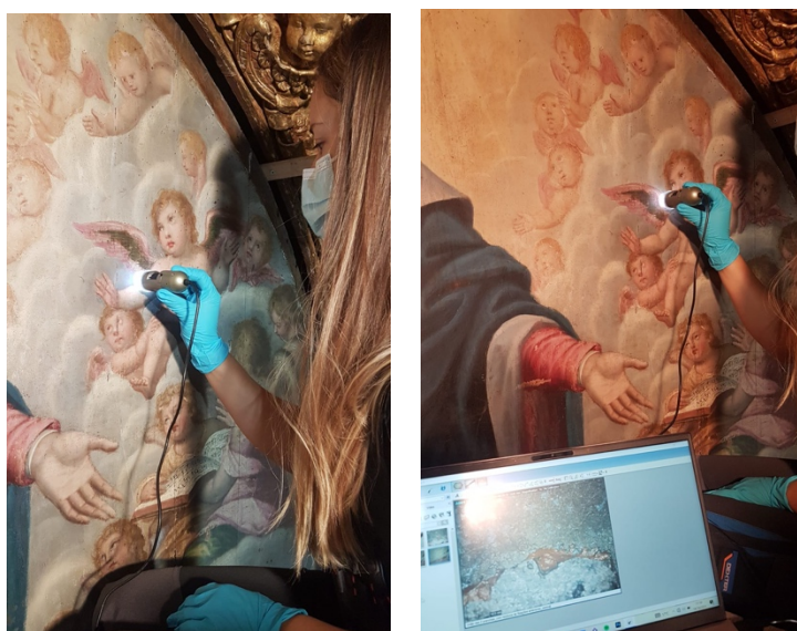
Figura 20 – Análise da superfície pictórica através de microscópio digital portátil (DinoLite®).
