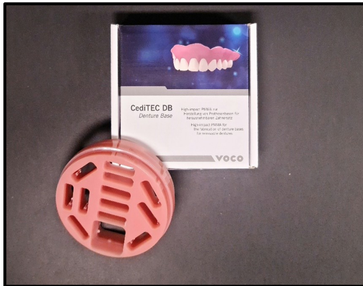
Figura 12. Bloco de PMMA após fresagem dos provetes.
