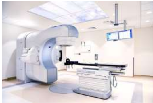
Figura 2- Acelerador linear produtor de feixes de eletrões e de fótons de alta energia (na gama dos MeV). [10]
