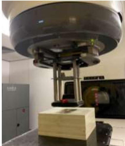
Figura 29- Irradiação dos filmes radiocrômicos GAFChromic EBT-3.
