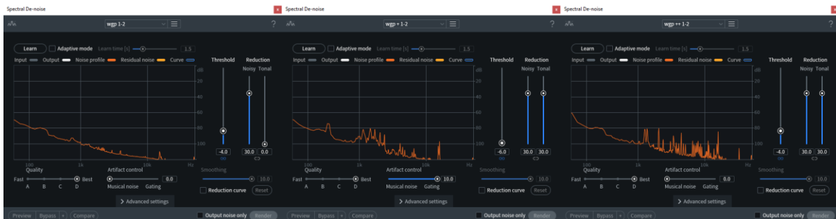
Figura 43 Comparação de perfis de ruído do woodland grand piano – perfil normal seguido das duas variações de ruídos causadas pelo sistema do Disklavier
