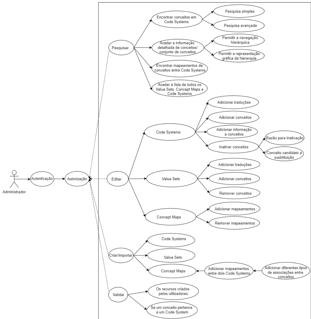
Figura 3.3 – Caso de uso do módulo de pesquisa, edição, criação, importação e validação do ST proposto.
