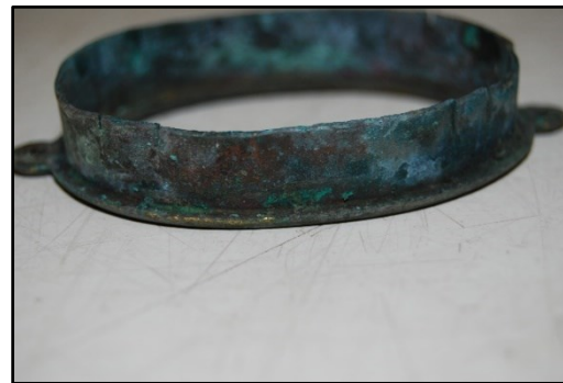
Figura 136 - Pormenor da corrosão de aro de liga de cobre que não foi dourado no interior. ©Diana Cunha, 2016
