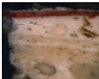
Figura 102 - AGAT.156: corte estratigráfico de área cromática branca. © Diana Cunha, 2018
