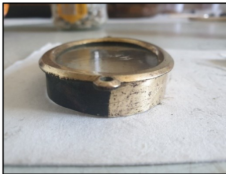
Figura 135 - Pormenor da oxidação do verniz em aro de liga de cobre dourado no interior. ©Diana Cunha, 2019
