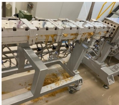
Figura 26- Produto a ser expelido pelas laterais do cooling die
