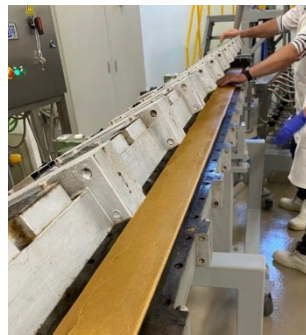
Figura 27- Cooling die aberto para limpeza
