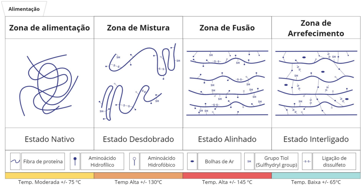
Figura 8- Processo de texturização esquematizado (adaptado de Ryu, 2020)
