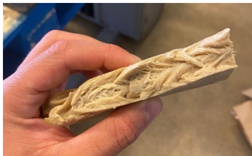
Figura 33- Tira do ensaio 2 dobrada a meio
