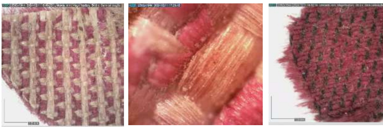
Figura 6 - 6a - Padrão de tecelagem com recurso a microscopia digital (amostra 00579_1) (54.9x). 6b - Ampliação com microscopia ótica (amostra 00579_1). 6c - Padrão de tecelagem com recurso a microscopia digital (amostra 00577_1) (55.3x). Imagens da autora©.
