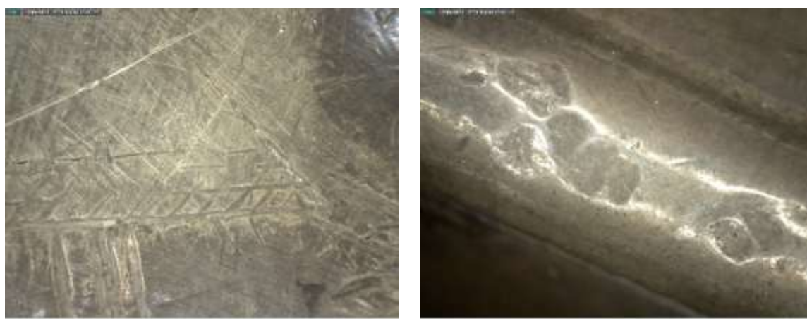
Figura 16 - 16a - Riscos visíveis por ampliação com microcopia digital. 16b - Zonas côncavas da dobradiça. Imagens da autora©.
