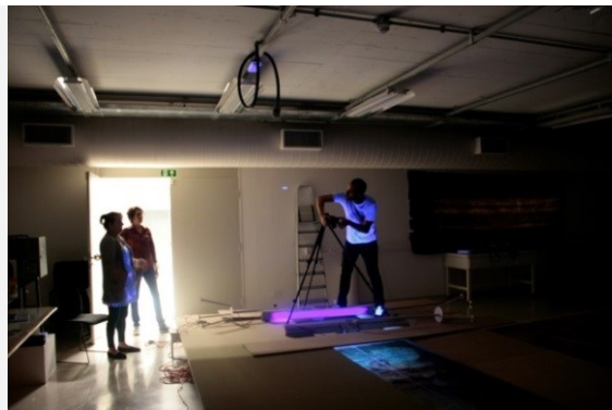
Fig. 97: Fotos com lâmpadas ultravioletas UV em ambiente totalmente escuro com uso de câmera Cannon ISO: 320; 50mm; f/16; 30s.
