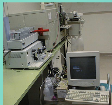
Fig. 1 - Montagem do sistema de fluxo multicomutado para a determinação de mercúrio: T, solução transportadora HCl 3% (v/v); R, solução redutora NaBH 4 0,2% (m/v) em NaHO 0,05% (m/v); A, amostras ou soluções padrão; B 1 e B 2 , bombas peristálticas; V 1 - V 3 , válvulas solenóides; RC, reactor L=30 cm; Ar, argón 70 mL min -1 ; SGL, separador gás-líquido; AA, espectrofotómetro de absorção atómica; E, esgoto.
