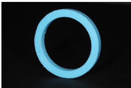
Figura 6 - Molde em PLA (20mm x 3m)
