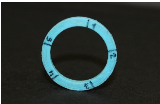
Figura 14 - Cinco pontos aleatórios de medição, marcados no molde de PLA
