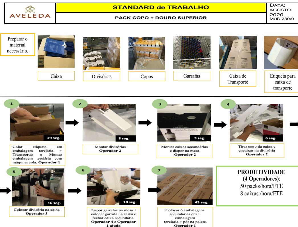
Figura 10 Standard de trabalho de montagem do Pack Douro Superior
