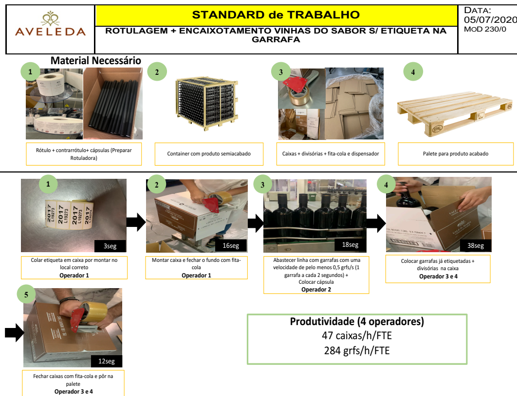
Figura 17 Standard de trabalho da rotulagem e encaixotamento do vinho Vinhas do sabor sem etiqueta na garrafa
