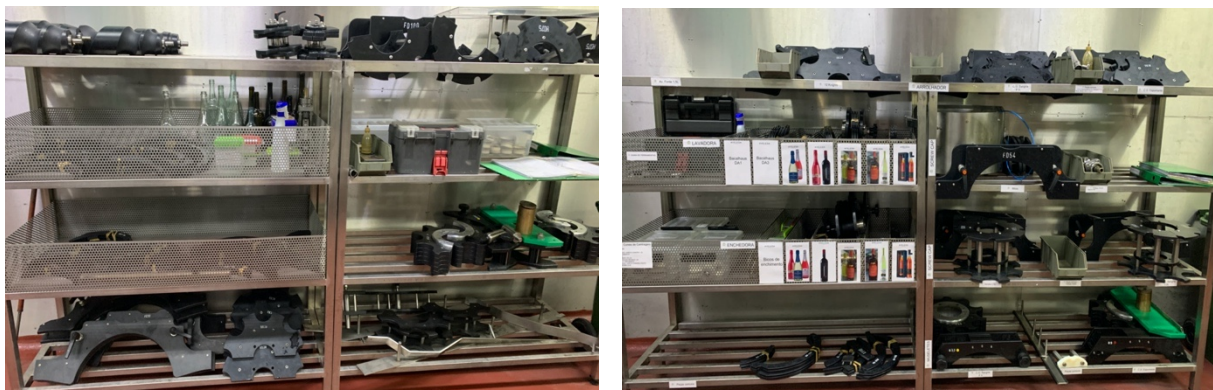
Figura 5.10 Estado e disposição das peças utilizadas no bloco de enchimento antes (esquerda) e depois (direita) da implementação do 5S na linha 3
