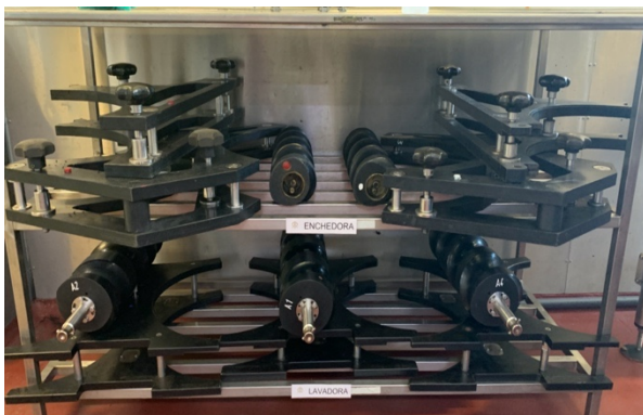
Figura 5.9 Estado e disposição das peças utilizadas no bloco de enchimento depois da implementação do 5S na linha 2
