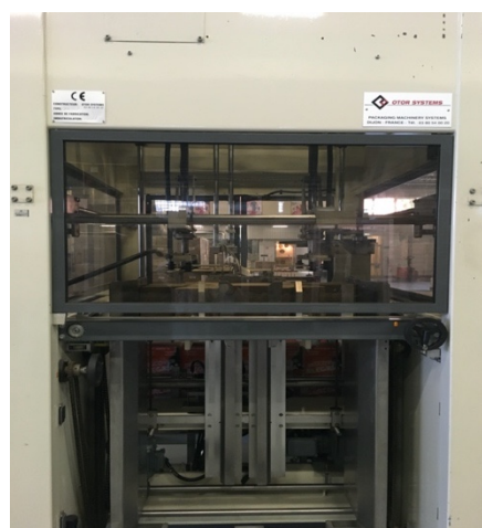
Figura 2.13 Máquina de colocar divisórias - Linha 1
