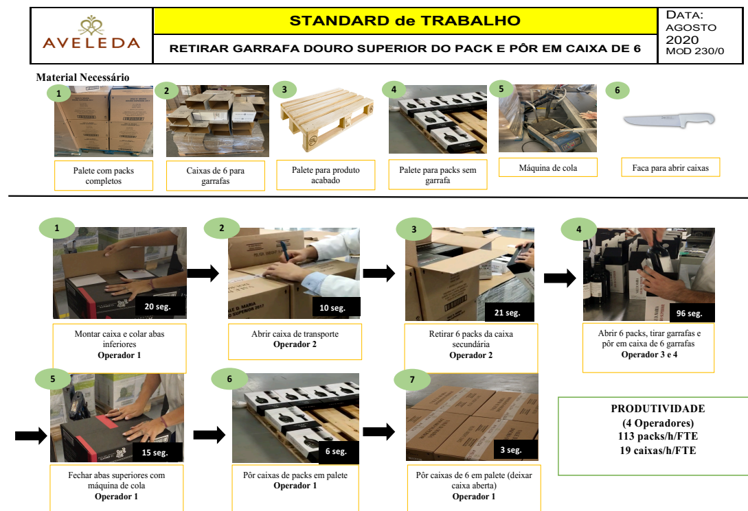
Figura 11 Standard de trabalho para a remoção de garrafa do pack de Douro Superior e pôr em caixa de 6
