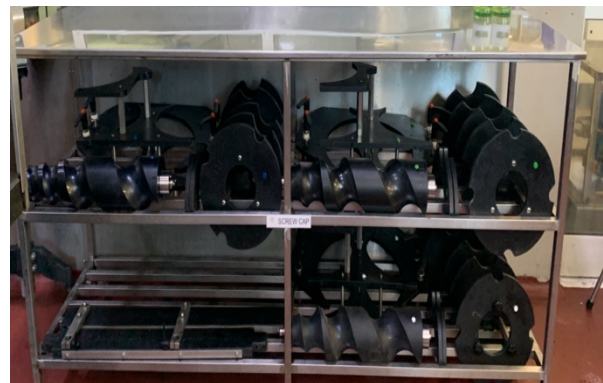
Figura 5.9 Estado e disposição das peças utilizadas no bloco de enchimento depois da implementação do 5S na linha 2
