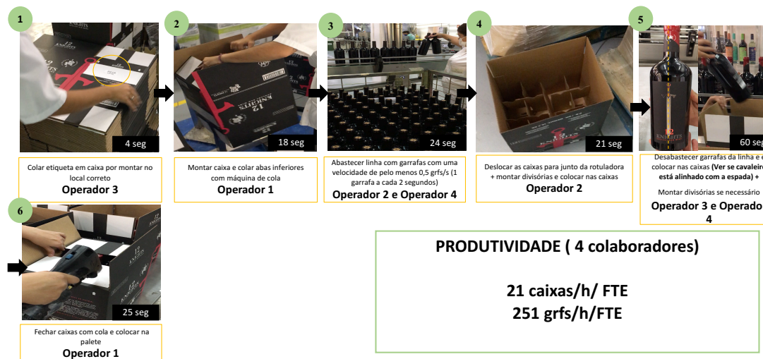
Figura 14 Standard de trabalho de Rotulagem + Encaixotamento 12 Knights
