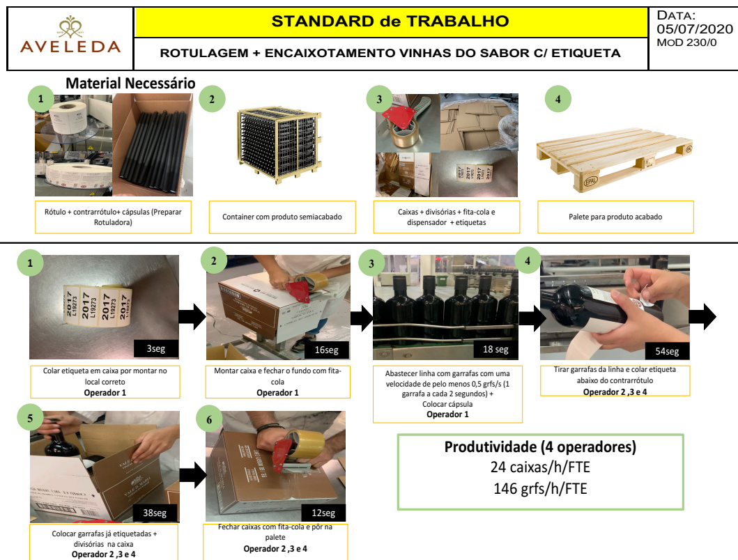
Figura 16 Standard de trabalho da rotulagem e encaixotamento do vinho Vinhas do sabor com etiqueta na garrafa
