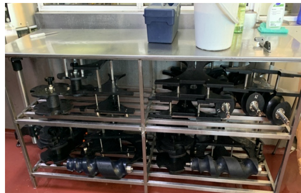
Figura 5.8 Estado e disposição das peças utilizadas no bloco de enchimento antes da implementação do 5S na linha 2
