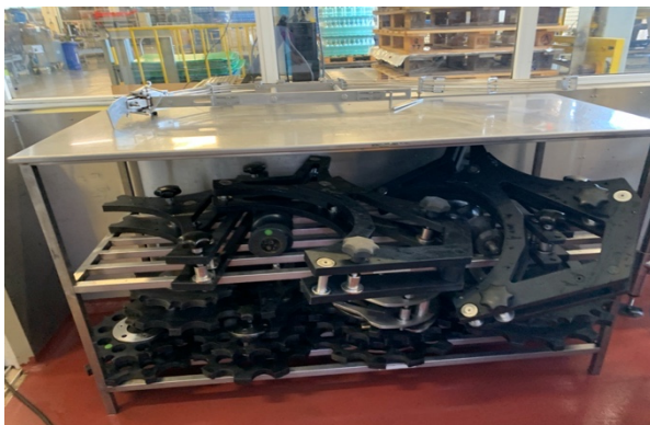
Figura 5.8 Estado e disposição das peças utilizadas no bloco de enchimento antes da implementação do 5S na linha 2
