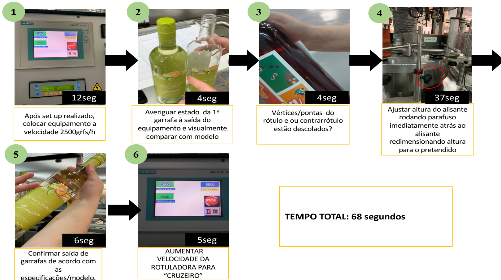
Figura 5 Standard de afinação rotuladora linha 2 (rótulos com vértices deslocados)
