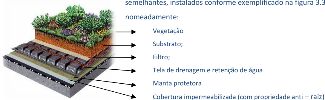
Figura 3.3 – Esquema em corte longitudinal de uma cobertura ajardinada.
