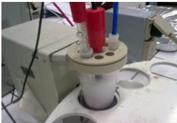
Figura 4.2 - Determinação da acidez
