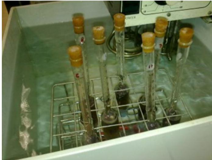
Figura 4.1 - Representação da Técnica de Van Gulik NP-2105,1983
