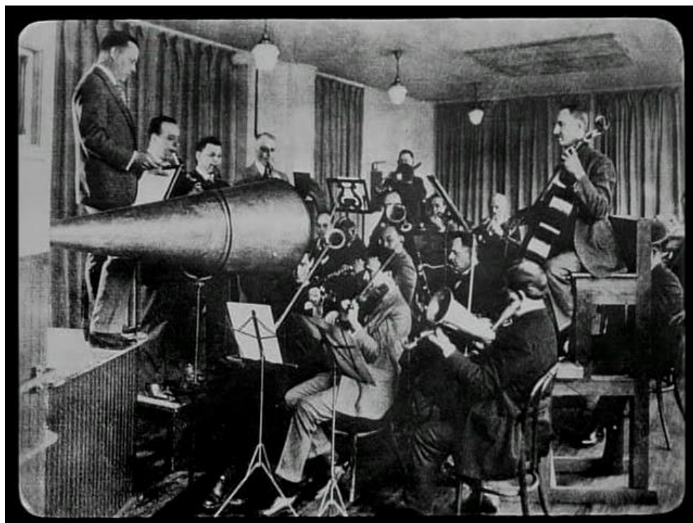
Figura 2 – Em 1924, a gravação no fonógrafo implicava o uso de um funil acústico.
