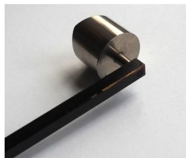
Figura 111 – Corrosão no aço do encaixe da haste polar. (Mariana Sá ©) Figura 112- Desgaste da haste e peso cilíndrico. (Mariana Sá ©)
