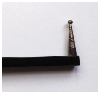
Figura 111 – Corrosão no aço do encaixe da haste polar. (Mariana Sá ©) Figura 112- Desgaste da haste e peso cilíndrico. (Mariana Sá ©)
