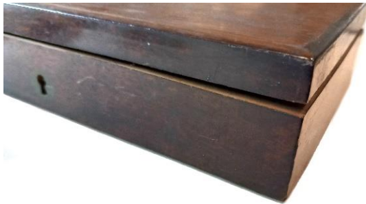
Figura 297- Deformação do encaixe da tampa. (Mariana Sá ©)
