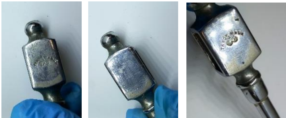
Figura 395, 396 e 397 - Cabeça do patim de fixação depois da limpeza(Mariana Sá ©)
