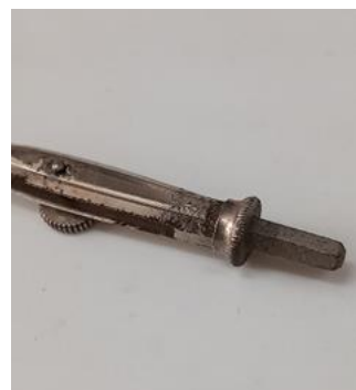
Figura 379, 380 e 381– Desgaste e corrosão na ponta tira-linhas (Mariana Sá ©)
