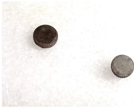
Figura 316 - Parafusos antes e depois do tratamento. (Mariana Sá ©)
