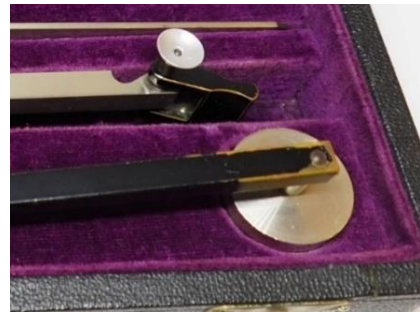
Figura 442- Pormenor do desgaste do planímetro (Mariana Sá ©)
