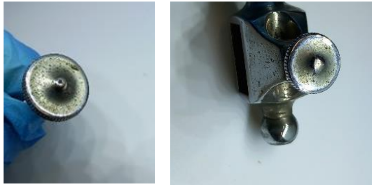
Figura 389 e 390 - Parafuso de fixação do patim de desenho antes de tratamento (Mariana Sá ©)
