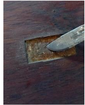
Figura 308 - Remoção da cola com bisturi. (Mariana Sá ©)
