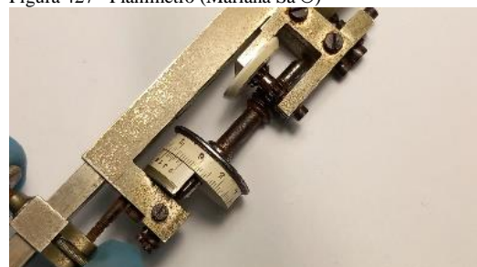
Figura 429- Ferrugem nos parafusos do Planímetro (Mariana Sá ©)
