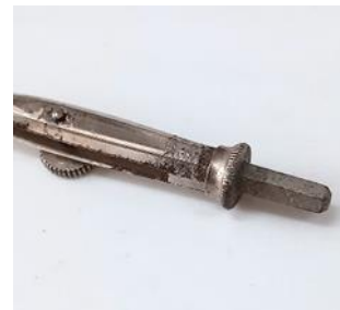
Figura 84- Desgaste na ponta de tinta (Mariana Sá ©)
