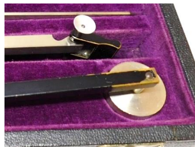
Figura 109- Desgaste do couro no canto do estojo. (Mariana Sá ©) Figura 110- Desgaste da haste do planímetro. (Mariana Sá ©)
