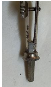
Figura 379, 380 e 381– Desgaste e corrosão na ponta tira-linhas (Mariana Sá ©)
