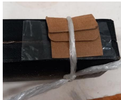
Figura 422- Fixação do estojo enquanto a secagem da cola. (Mariana Sá ©)
