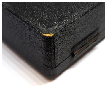
Figura 109- Desgaste do couro no canto do estojo. (Mariana Sá ©) Figura 110- Desgaste da haste do planímetro. (Mariana Sá ©)
