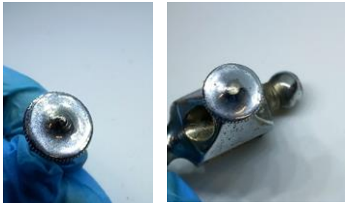
Figura 391 e 392 - Parafuso de fixação do patim de desenho depois do tratamento (Mariana Sá ©)
