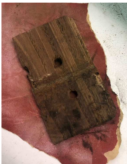
Figura 35 - Limpeza mecânica das taleiras
