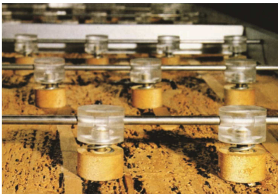
Figura 43 - Mecanismo de molas desenvolvido no ICR nos anos 1979–80
