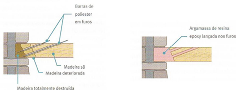
Figura 5.2 – Injeção de resina epoxy para reconstituição de zona deteriorada de viga de madeira [36].
