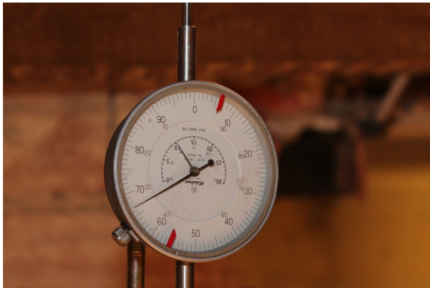
Figura 8.5 – Medição das deformações.
