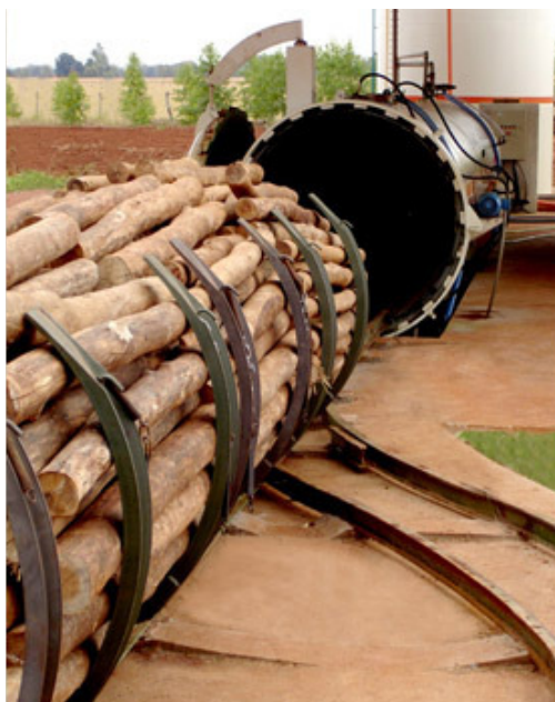
Figura 4.1 – Autoclave com carga de madeira prestes a entrar [32].
