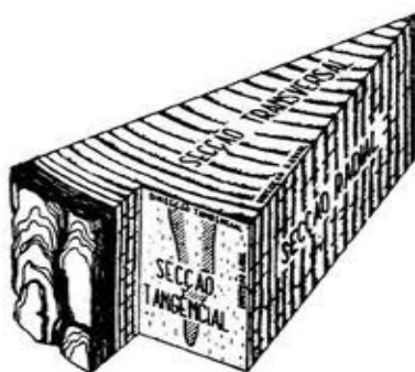
Figura 2.2 – Secções principais da madeira [6].
