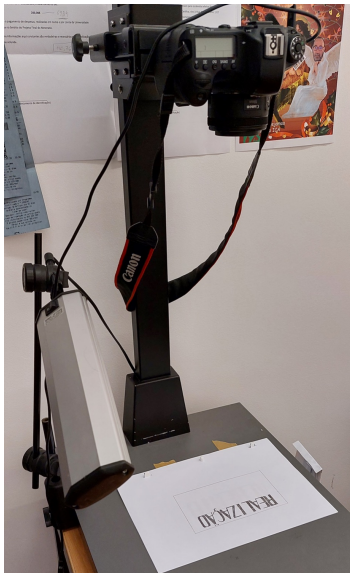
Figura 31 - Estrutura que segura a câmara com uma pequena peg bar para segurar as folhas.
