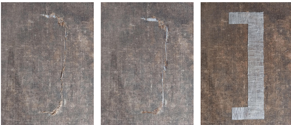
Figura 57: Procedimento de reforço das uniões dos rasgões com agrafos.
