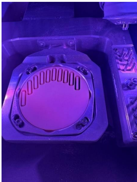
Figura 8 – Disco de resina inserido na fresadora no final do processo de fresagem
