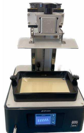
Figura 11 – Resina de impressão 3D depositada no tanque de impressão.
