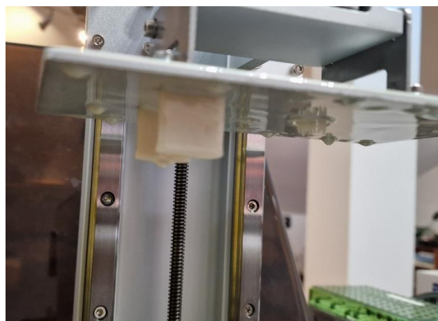
Figura 12 – Provetes aderidos à plataforma elevatória da impressora no final do processo de impressão.
