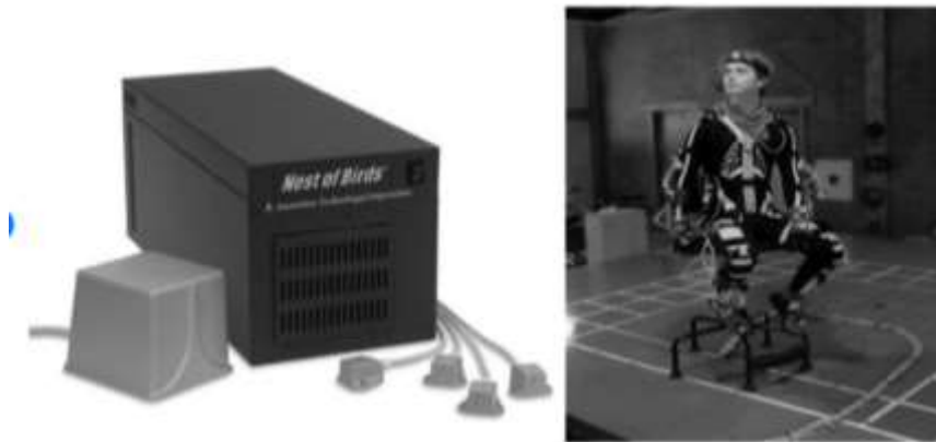
Figura 2- Transmissor e um ator a usar um fato com sensores magnéticos
