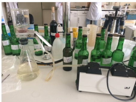
Figura 2.6 Conjunto de filtração
