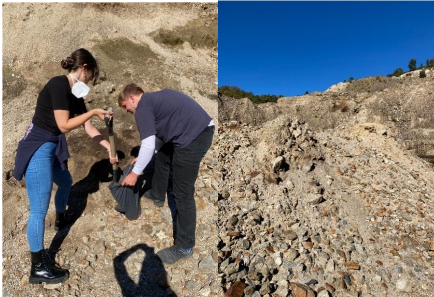
Figura 8. Recolha de "solo" da escombreira para execução do ensaio em vaso (©Nadine Rodrigues).
