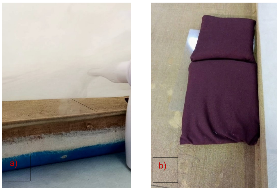
Figura 26: a) aplicação de humidade por humidificador ultrassônico e b) pesos para planificação das telas. Fonte: autora©
