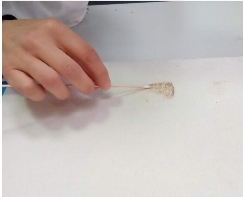
Figura 29: Limpeza com as microemulsões. Fonte: autora©
