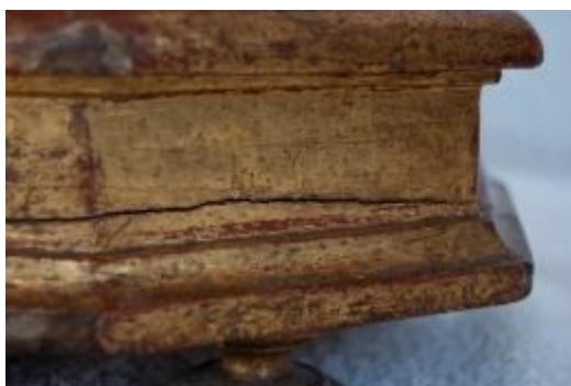
Fig. 126 - NIDN: área da recolha de amostra de ouro da peanha.
