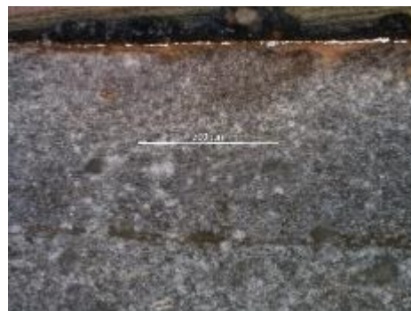
Fig. 7 - SFCV.56: corte de área cromática castanha, repolicromia (PLM – nicóis paralelos).
