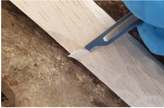
Fig. 822 - Nivelamento com bisturi do preenchimento de lacuna com madeira de balsa.
