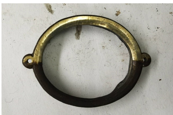
Fig. 810 - Remoção do filme de verniz oxidado do aro de cobre dourado.
