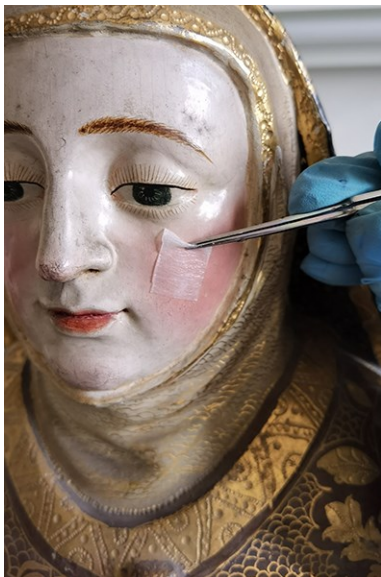
Fig. 788 - Aplicação de filtro de papel húmido na superfície policroma para medição de pH e condutividade.
