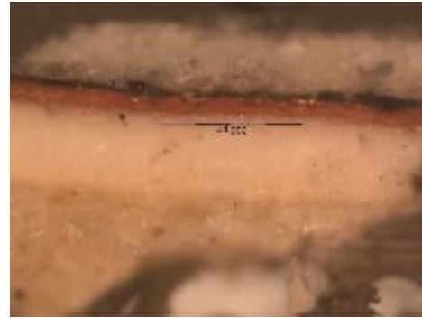
Fig. 367 - CLAR.197: corte de área cromática castanha, original (PLM – nicóis paralelos).
