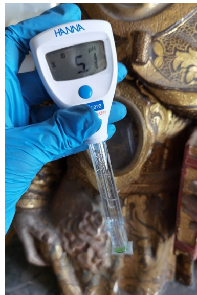
Fig. 789 - Medição de pH da superfície policroma.
