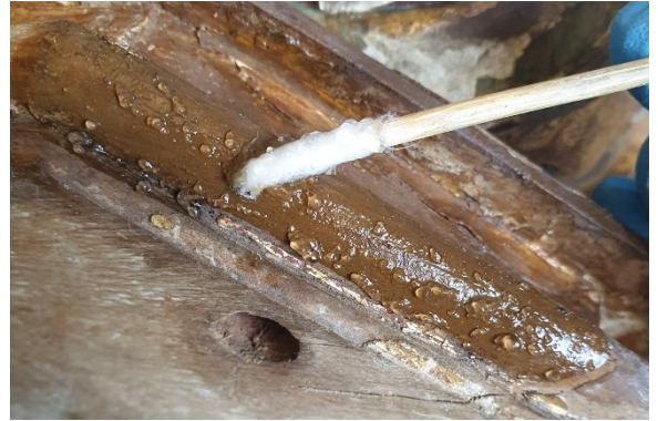
Fig. 858 - Aplicação de solução de solventes gelificada para remoção de substância filmogénica desconhecida.
