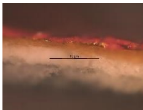
Fig. 571 - SMBE.100: corte de área cromática vermelha (PLM – nicóis paralelos).
