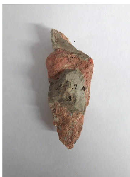
Fig. 39 y 40 Muestra 1. Fragmento de hormigón analizado con Micro EDX.
