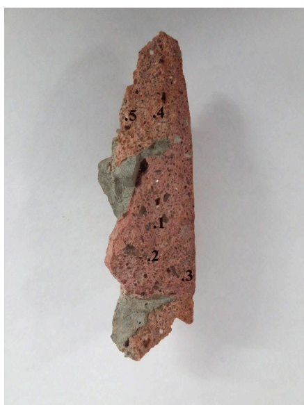
Fig. 39 y 40 Muestra 1. Fragmento de hormigón analizado con Micro EDX.
