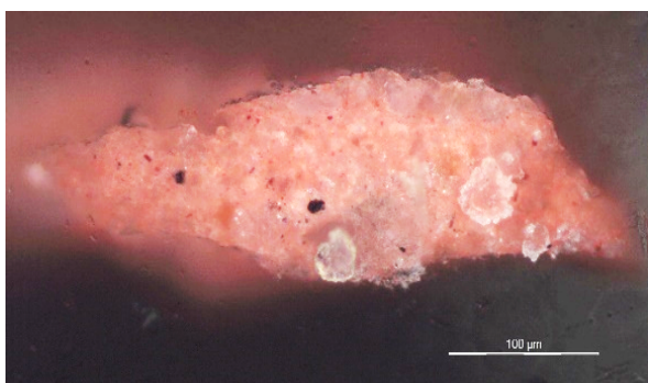
Fig. 21 Muestra estratigráfica M6 (200x), correspondiente al costado izquierdo inferior del tronco de la figura femenina.
