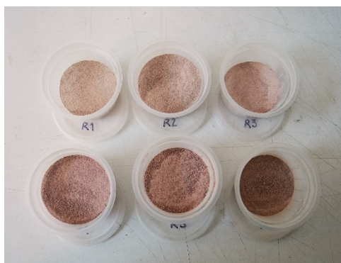
Fig. 113 Polvo pigmentado obtenido de moler fragmentos de la capa superficial de la escultura.
