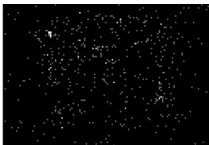
Fig. 30 Mapa de EDS. Hierro (Fe) en muestra M8 (160x).
