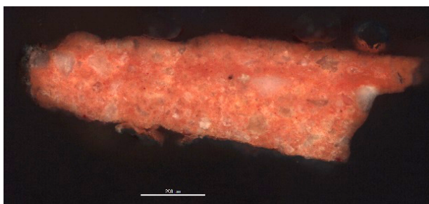
Fig. 20 Muestra estratigráfica M5 (100x), correspondiente al hormigón pigmentado en la zona centro interior de la espalda de la figura masculina.
