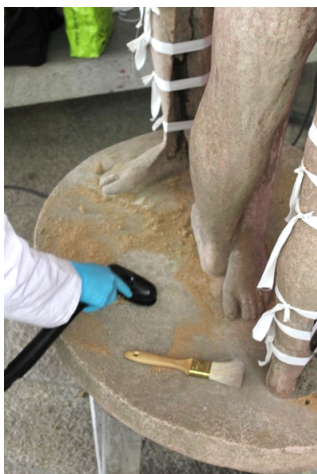
Fig. 77 Remoción de suciedad con brocha y aspirador.
