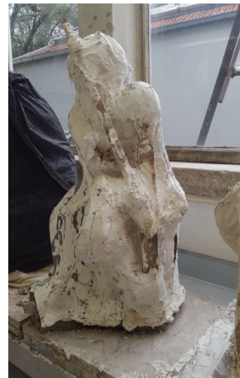
Fig. 12 Ejemplo de molde con trozos de esparto para dar cohesión al yeso, y piezas de madera para controlar la distribución de la fuerza en la apertura del molde.
