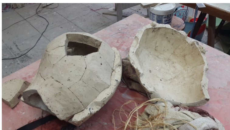
Fig. 10 Ejemplo de molde realizado con piezas divididas por medio de barreras de barro (izquierda) y contramolde para encajar las piezas y mantenerlas orientadas (derecha).
