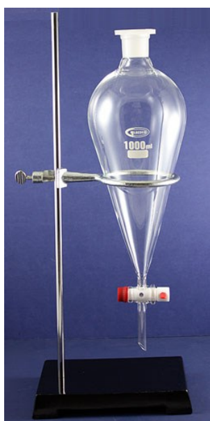
Figura 3.1- Montagem da ampola de decantação ( Glassware , 2017)
