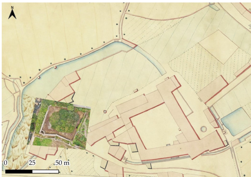
Mapa 23 - Sobreposição georreferenciada do tanque de 1918-21 sobre planta da fábrica na quadrícula 109 de Teles Ferreira, de 1892.
