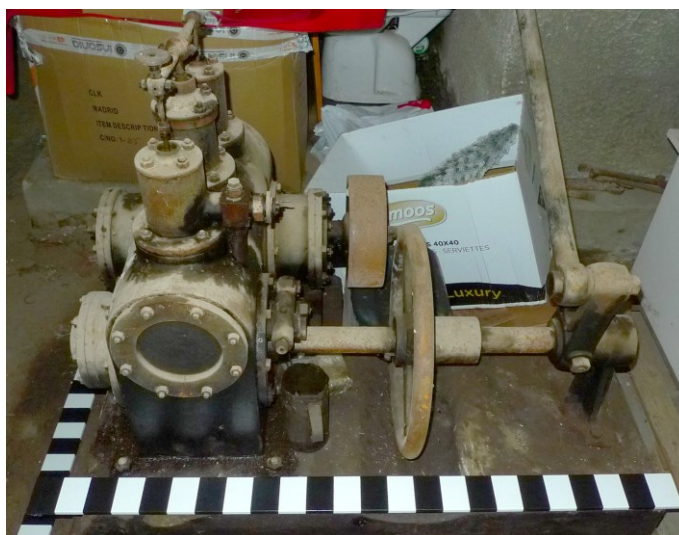
Fig. 32 - Perspetiva lateral do controlador automático de fluxo da turbina, também designando regulador de velocidade (©MBPastor).
